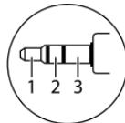
Para una óptima salida de audio, se recomienda utilizar una miniplaleta estéreo para enchufe de 3 terminales.
