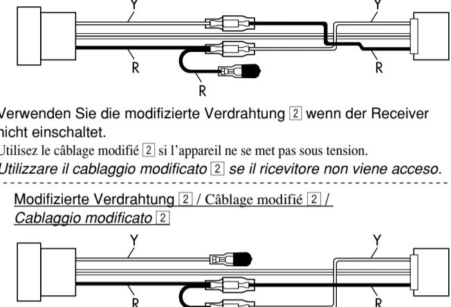
**B Anschlüsse ohne Verwendung der ISO-Steckverbinder / Connexions sans l'utilisation des connecteurs ISO / Collegamenti senza utilizzare i connettori ISO**
