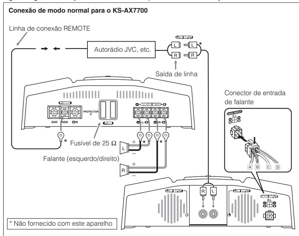
**Antes de conectar:** Conecte todas as partes adequadamente. Se as conexões se soltarem, devido a resistência do contato, etc., o calor produzido pode provocar acidentes. Prenda e cubra os cabos com fita isolante e passe-os sob os tapetes do carro.
