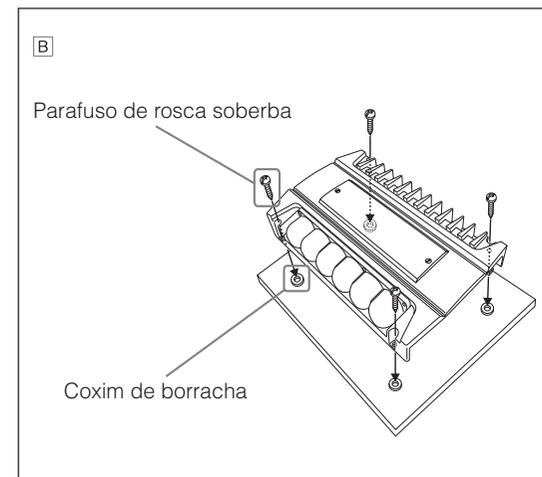
**B** Quando estiver instalando este aparelho, utilize os parafusos e coxins fornecidos (como ilustrado). Se algum outro parafuso for utilizado, há o risco de má fixação ou de danos internos.
