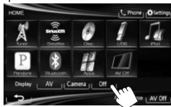
**Para activar la pantalla:** Pulse y mantenga pulsado DISP en el panel del monitor, o toque la pantalla.
