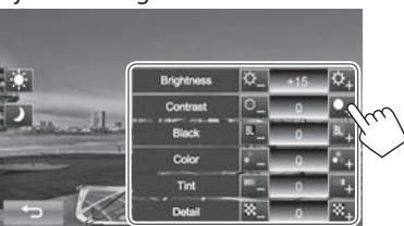
**<Brightness>** Ajuste la luminosité. (-15 à +15)
