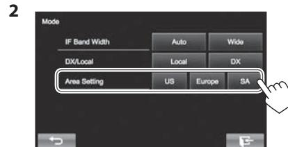
**[US]** Choisissez ce réglage lors de l'utilisation de l'appareil en Amérique du Nord/Centrale/du Sud. L'intervalle de fréquences FM/AM est réglé sur 200 kHz/10 kHz.
