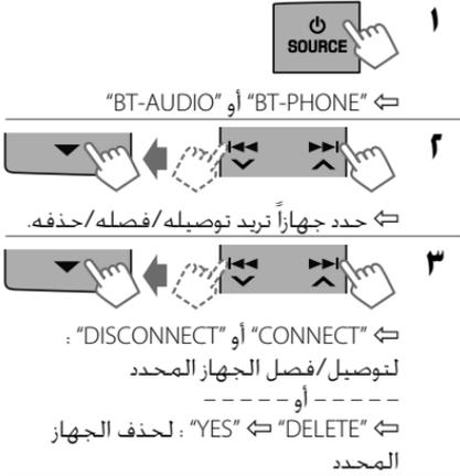
يمكنك ضبط الوحدة بحيث تتصل بالجهاز المزود بالبلوتوث تلقائياً عند تشغيلها. ("AUTO CNNECT").
