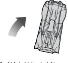
Move the TRIM CONTROL LEVER toward the "R" p Test and repeat until vehicle is driving straight Déplacer le LEVIER DE COMPENSATION vers la droite (position « R »). Vérifier la trajectoire et répéter l'opération jusqu'à ce que le véhicule avance droit.
