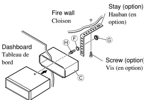
Install the receiver at an angle of less than 30°. Installez l'appareil avec un angle de moins de 30°.
