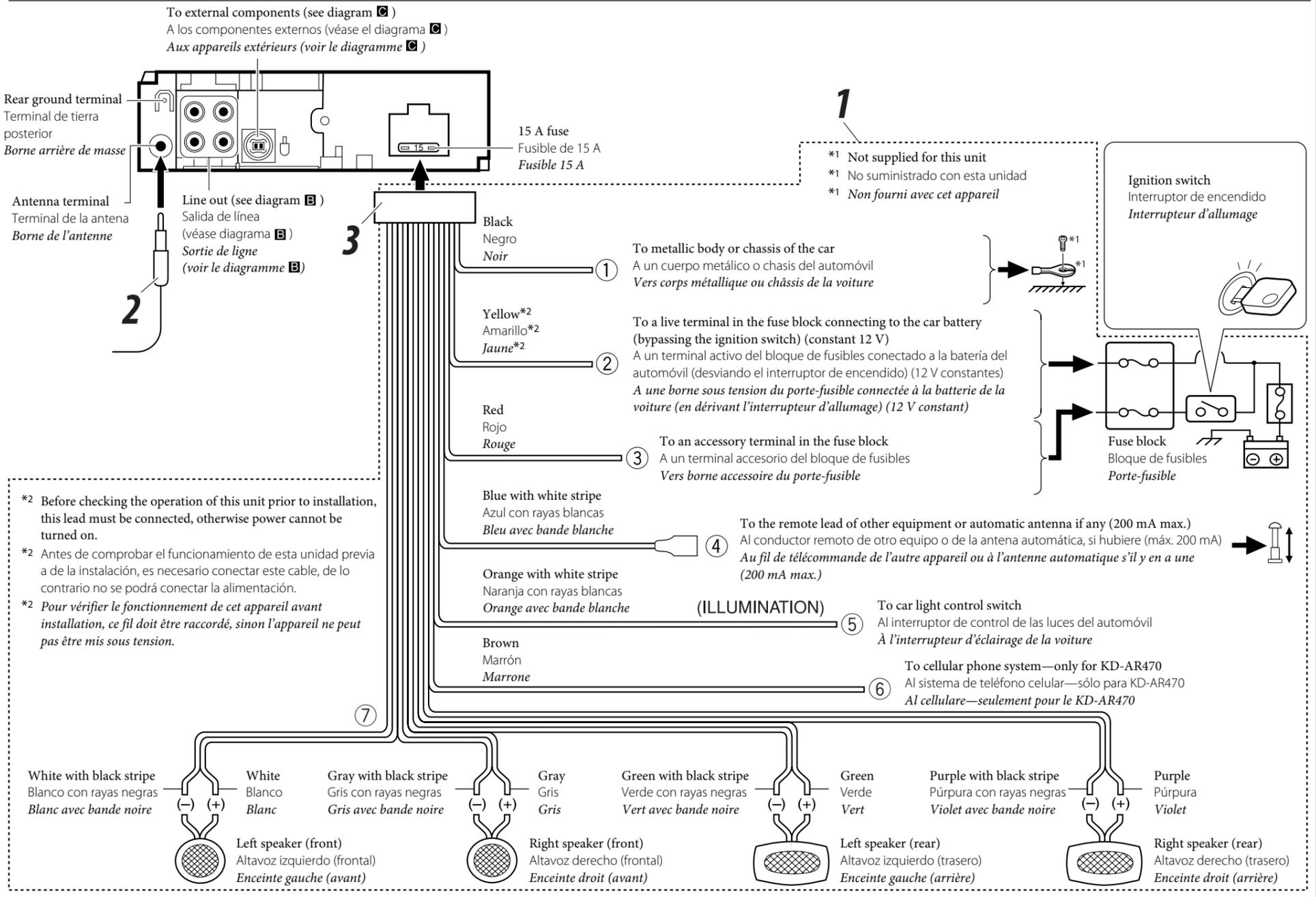
**B Connecting the external amplifiers / Conexión a los amplificadores externos / Connexion d'amplificateurs extérieurs**
