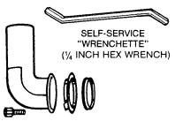
DISCHARGE TUBE, GASKET, METAL FLANGE AND SCREW(S)
