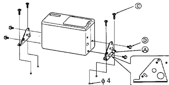
**In case of hanging in the trunk / Lorsqu'on suspend le changeur à l'intérieur du coffre
