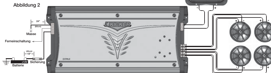
(ZX550.3) Zweikanalbetrieb mit Subwoofer
