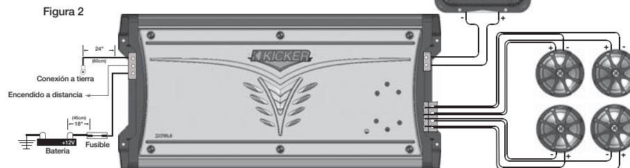
(ZX700.5) Funcionamiento por cuatro canales con subwoofer
