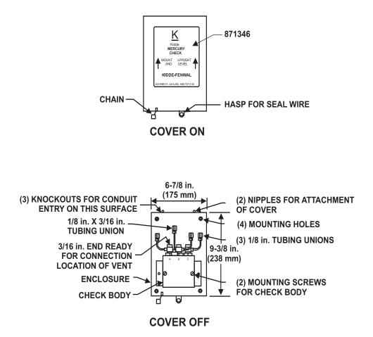
Figure B-1. 3-Well Mercury Check
