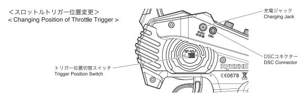
送信機裏面のスイッチを移動させることで、スロットルトリガーの作動範囲を7:3、5:5の2種類選択できます。なお、変更するとスロットルサーボのニュートラル位置も移動してしまいますので再調整が必要です。
