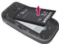
**Advertencia** No retire la batería cuando el teléfono esté encendido porque puede dañarlo.
