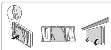
Après avoir changé le filtre, poussez et maintenez le bouton du filtre Fresh pendant trois secondes pour réinitialiser le capteur de filtre.
