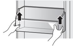
Pour remettre en place le balconnet, alignez les deux côtés du balconnet sur les glissières et poussez le balconnet vers le bas jusqu'à ce qu'il s'enclenche.
