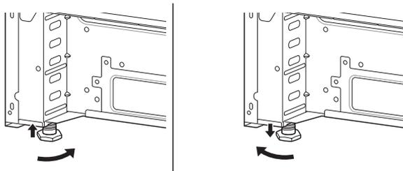
Utilice un nivelador para verificar sus ajustes. Ubique el nivelador en diagonal sobre el estante del horno y verifique en todas direcciones para nivelar.
