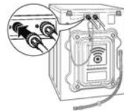
Conexión de los tubos de agua
