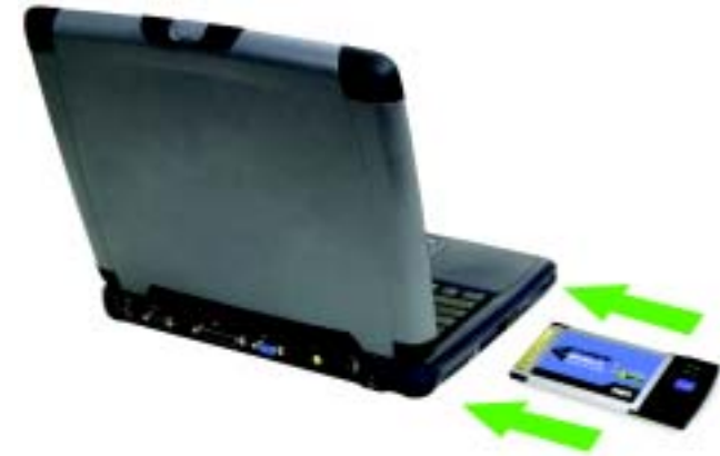
Abbildung 5-1: So installieren Sie den Adapter in Ihrem Notebook
