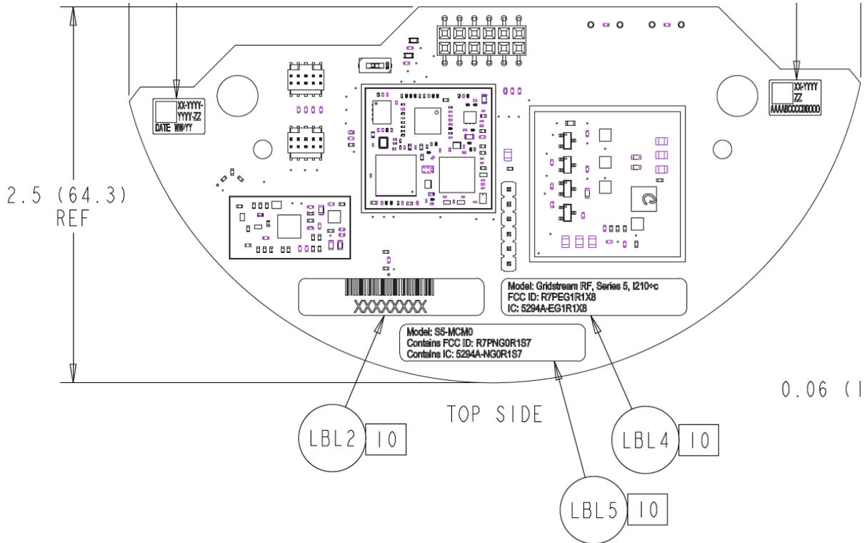
Figure 7. I210+c module FCC/IC labels
