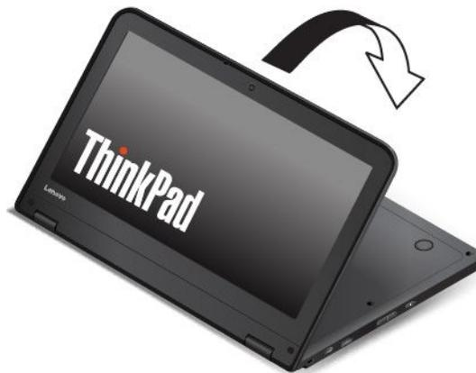
2. 按所示方式放置计算机。此时计算机处于平板电脑模式。缺省情况下启用自动旋转功能。
