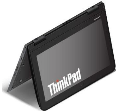
在帐篷模式下，将自动禁用键盘、轨迹板、TrackPoint 按键和 TrackPoint 指点杆。但是，可以通过特殊按键和多点触控式屏幕来控制计算机的某些功能，而无需使用键盘和轨迹板。如需更多信息，请参阅第 21 页“使用特殊按键”和第 19 页“使用多点触控式屏幕”。
