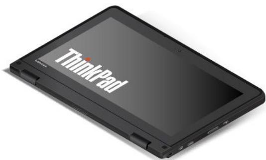
在平板电脑模式下，将自动禁用键盘、轨迹板、TrackPoint 按键和 TrackPoint 指点杆。但是，可以通过特殊按键和多点触控式屏幕来控制计算机的某些功能，而无需使用键盘和轨迹板。如需更多信息，请参阅第 21 页“使用特殊按键”和第 19 页“使用多点触控式屏幕”。
