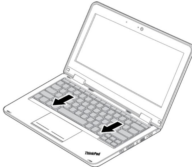
4. Cierre la pantalla del equipo y coloque el sistema boca abajo. Instale los tornillos para fijar el teclado.
