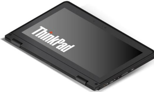
En la modalidad de tableta, el teclado y el área táctil se deshabilitan automáticamente. Sin embargo, puede controlar algunas funciones del sistema mediante los botones especiales y la pantalla multitáctil, sin tener que utilizar el teclado y el área táctil. Para obtener más información, consulte “Uso de los botones especiales” en la página 24 y “Uso de la pantalla multitáctil” en la página 22.
