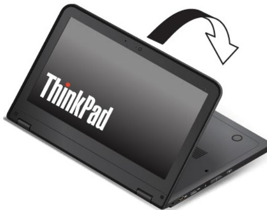
2. Coloque el sistema como se muestra. El equipo ahora está en modalidad de tableta. De forma predeterminada, la función de rotación automática está habilitada.
