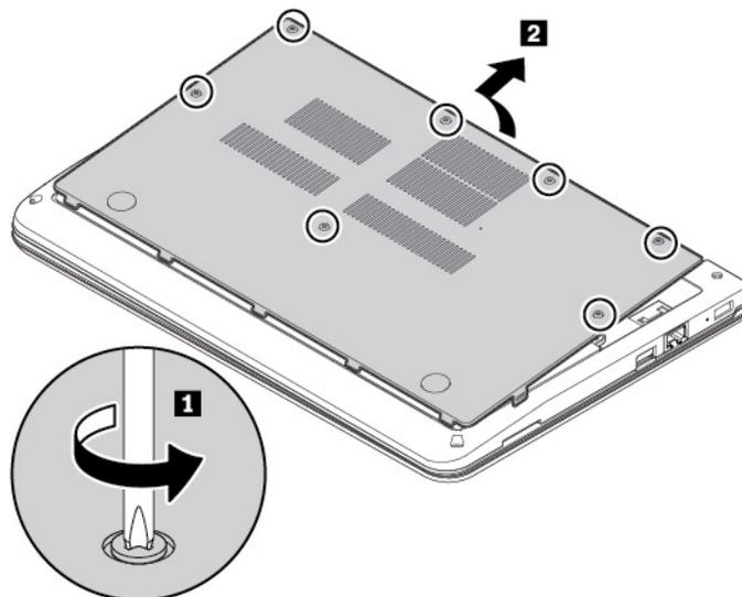
5. Instale el nuevo conjunto de cubierta de la base en su lugar. Apriete los tornillos para asegurar el conjunto de cubierta de la base.
