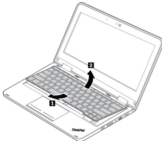
8. Coloque el teclado en el reposamanos como se indica y desconecte el conector. Extraiga el teclado.
