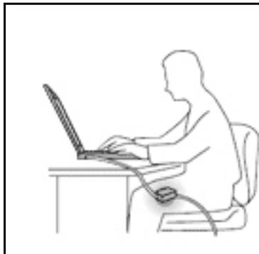
Cuando el adaptador de alimentación de CA está conectado a una toma de alimentación eléctrica y al sistema, genera calor.
