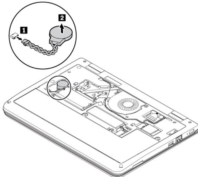
6. Instale la nueva batería plana **1** y conecte el conector **2**.
