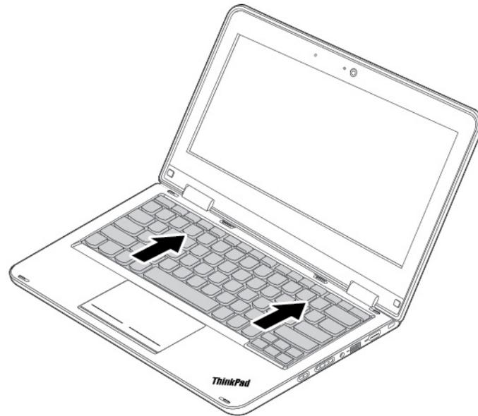
7. Levante un poco el teclado hacia arriba como muestra la flecha **1**. Gire el teclado ligeramente hacia arriba como muestra la flecha **2** hasta que vea los conectores en la parte inferior del teclado.
