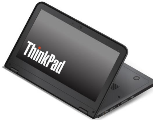
En la modalidad de pedestal, el teclado y el área táctil se deshabilitan automáticamente. Sin embargo, puede controlar algunas funciones del sistema mediante los botones especiales y la pantalla multitáctil, sin tener que utilizar el teclado y el área táctil. Para obtener más información, consulte “Uso de los botones especiales” en la página 24 y “Uso de la pantalla multitáctil” en la página 22.
