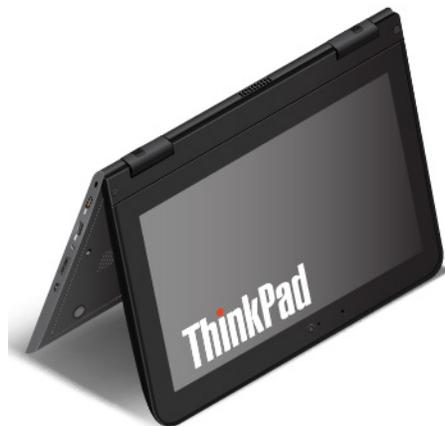
En la modalidad de lienzo, el teclado y el área táctil se deshabilitan automáticamente. Sin embargo, puede controlar algunas funciones del sistema mediante los botones especiales y la pantalla multitáctil, sin tener que utilizar el teclado y el área táctil. Para obtener más información, consulte “Uso de los botones especiales” en la página 24 y “Uso de la pantalla multitáctil” en la página 22.
