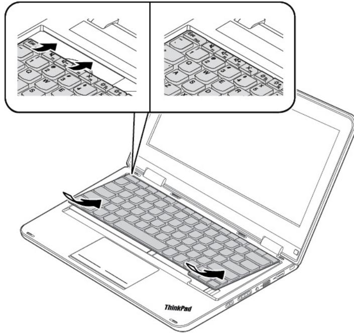
3. Deslice el teclado en la dirección que se muestra. Asegúrese de que los seguros bajo el marco del teclado se encuentra colocados.
