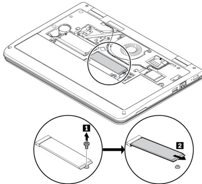
6. Inserte la nueva unidad de estado sólido M.2 en la ranura en un ángulo de unos 20 grados **1**. Gire la unidad de estado sólido M.2 hacia abajo **2** e instale el tornillo para fijar la unidad de estado sólido M.2 **3**.
