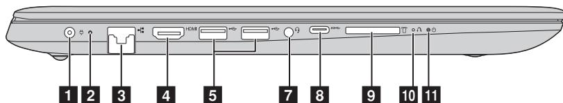
**1 AC 電源整流器插孔** 連接至 AC 電源整流器。
