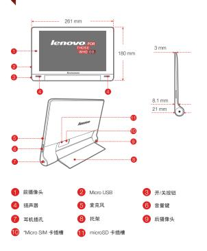
Ø WLAN 型号 (Lenovo B8080-F) 没有 Micro SIM 卡插槽。
