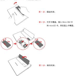
Ø YOGA TABLET 10 HD+ 只能使用 Micro SIM 卡。 !!!YOGA TABLET 10 HD+ 处于打开状态时切勿插拔 Micro SIM 卡。否则可能永久损 坏 Micro SIM 卡或 YOGA TABLET 10 HD+。
