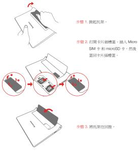
Ø 您的 YOGA TABLET 10 HD+ 僅能搭配 Micro SIM 卡使用。 !!! 請勿在 YOGA TABLET 10 HD+ 電源開啟的狀態下,插入或取出 Micro SIM 卡。 否則可能會對 Micro SIM 卡或 YOGA TABLET 10 HD+ 造成永久性的損壞。
