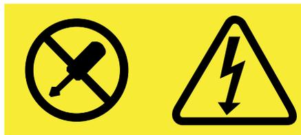
위와 같은 레이블이 부착되어 있는 모든 부품에는 인체에 위험한 전압이나 전하량 및 에너지 준위가 존재합니다. 이러한 부품의 내부에는 수리가 가능한 부분이 없습니다. 위와 같은 레이블이 부착된 부품의 고장이 의심스러운 경우, 서비스 센터에 문의하십시오.
