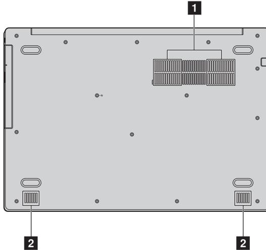
**1** **Belüftungsschlitze** Leiten Wärme ab.
