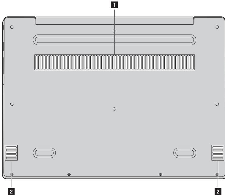
**1 散熱孔** 空氣可進入電腦，使電腦冷卻。
