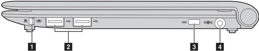
**1** **Interruptor de dispositivo inalámbrico integrado (en determinados modelos)**
