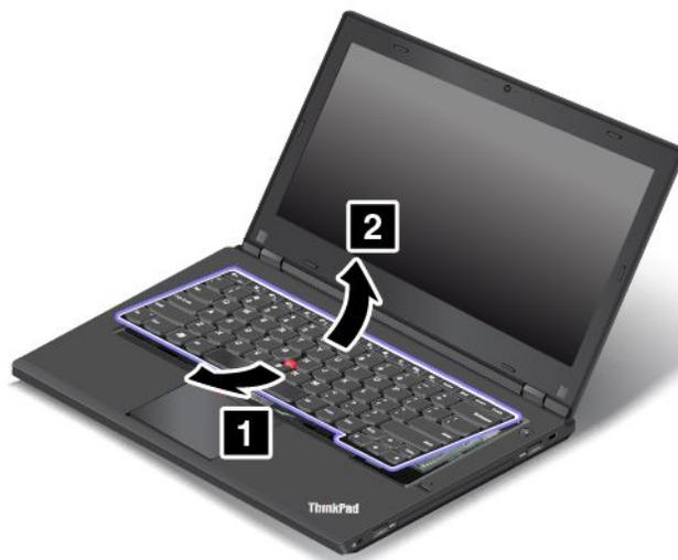
7. Coloque el teclado en el reposa manos y desconecte los conectores. Luego extraiga el teclado.
