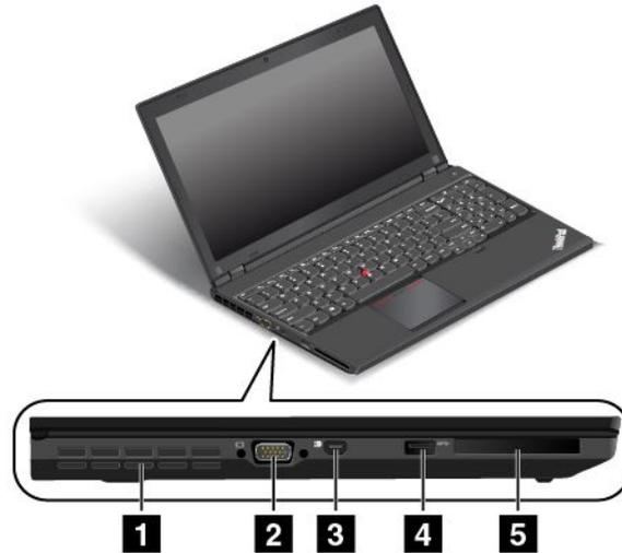
Figura 8. Vista del lateral izquierdo del sistema ThinkPad L540
