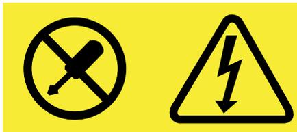
Hay niveles peligrosos de voltaje, corriente y energía al interior de cualquier componente que tenga esta etiqueta. Al interior de estos componentes no hay piezas que requieran ningún tipo de mantenimiento. Si sospecha que alguna de estas piezas presenta problemas, comuníquese con un técnico de servicio.
