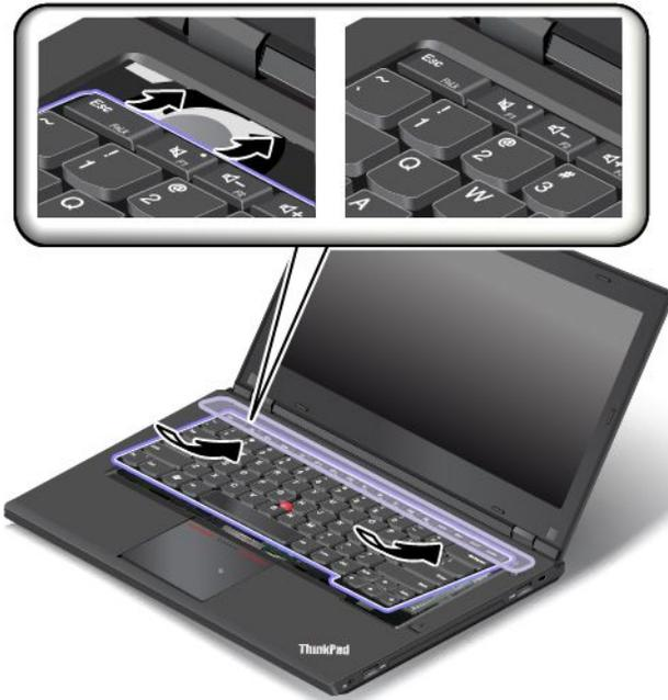
3. Asegúrese de que las cabezas de los tornillos queden completamente expuestas. De lo contrario, mueva las cabezas de los tornillos deslizando el marco del teclado hacia delante con el extremo plano de la herramienta múltiple del teclado.
