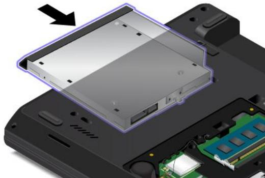
7. Instale el tornillo para fijar el nuevo dispositivo Ultrabay.
