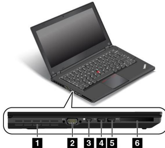
Figura 3. Vista del lateral izquierdo del sistema ThinkPad L440
