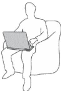
Cuando el sistema está encendido o la batería se está cargando, la base, el reposamanos y alguna otra parte del sistema pueden calentarse. La temperatura que alcanzan depende de la cantidad de actividad del sistema y del nivel de carga de la batería.
