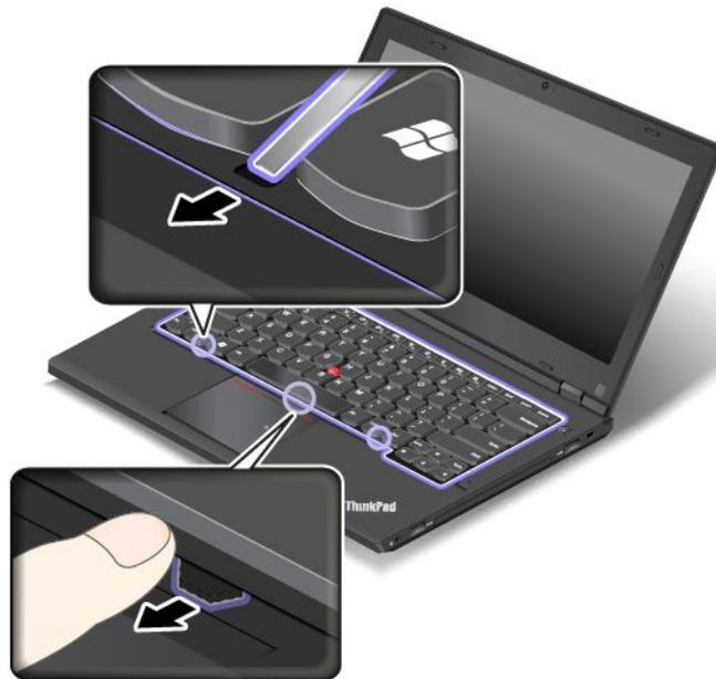
6. Inserte el extremo plano de la herramienta múltiple del teclado en los espacios entre las teclas como se muestra para deslizar el marco del teclado hacia atrás. Asegúrese de que no quede espacio entre el marco y el bisel del teclado.
