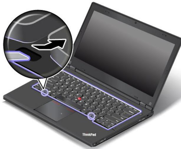
4. Kencangkan sekrup dengan ujung silang dari multi-alat keyboard untuk mengencangkan keyboard di tempatnya.
