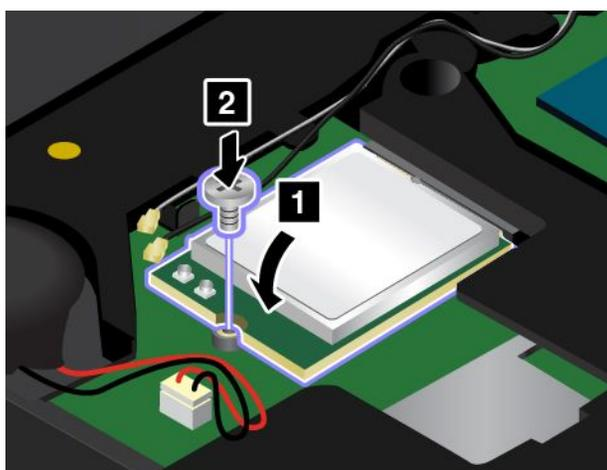
7. 將天線接線連接至新的無線 LAN 卡。請務必將灰色接線連接到卡上的主要接頭，然後將黑色接線連接到卡上的輔助接頭。
