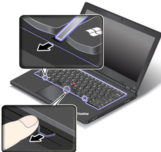
6. 如圖所示，將鍵盤多功能工具的平口端插入按鍵周圍的空隙，將鍵盤框架向後滑動。確定鍵盤框架和鍵盤擋板之間沒有空隙。
