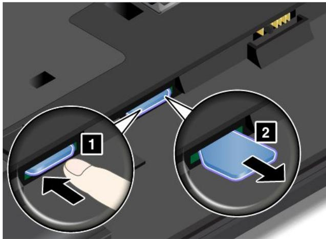
4. 將新 SIM 卡確實插入插槽，直到聽到卡嚓聲。
