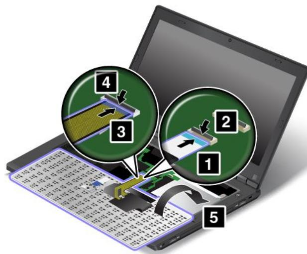
2. 如圖所示，將鍵盤插入鍵盤擋板。確定鍵盤的前緣在鍵盤擋板的框架下方。
