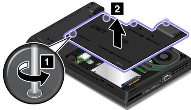
4. 卸卡固定硬碟或固態硬碟的螺絲。
