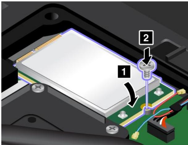
9. 將天線接線連接至新的無線 WAN 卡。請務必將紅色接線連接到卡上的主要接頭，然後將藍色接線連接到卡上的輔助接頭。
