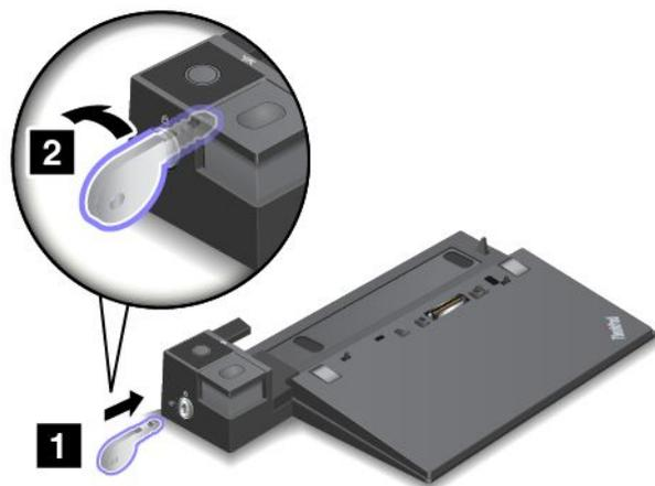
3. 將電腦的左上角對準擴充基座的定位標記。垂直地將電腦放入擴充基座，直到聽到喀嚓聲 **1**。電腦現已連接到擴充基座。然後將系統鎖定鑰匙轉到鎖定位置 **2**。
