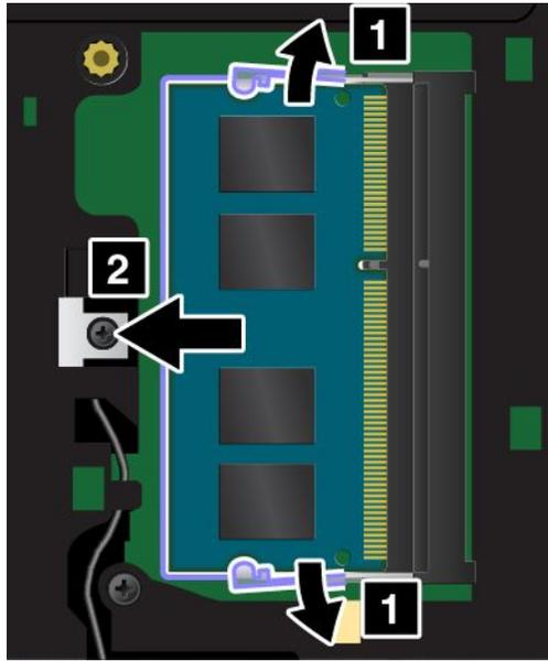
5. 將新記憶體模組缺口末端朝向記憶體插槽的連接邊緣端，然後以大約 20 度角將記憶體模組 **1** 插入插槽。將記憶體模組向下旋轉，直到它卡入定位 **2**。請確定記憶體模組已妥當安裝在插槽中，不會輕易脫落。
