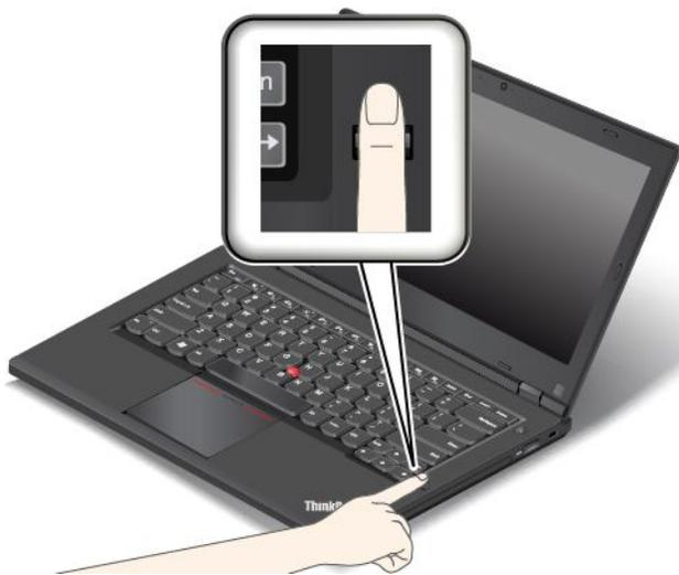
2. 輕輕按壓辨識器，然後將手指往自己的方向順暢地滑過辨識器。滑動手指時，請勿抬起手指。
