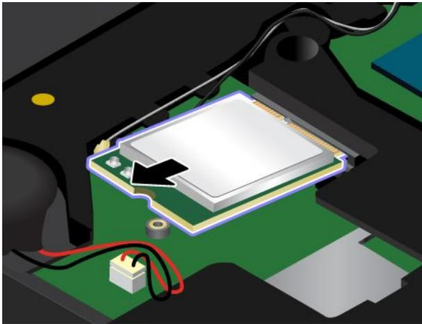
5. 將新無線 LAN 卡的缺口與插槽中的突起部分對齊。然後小心地將卡片以大約 20 度角插入插槽。
