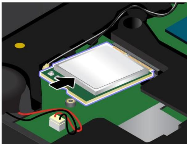
6. 將新的無線 LAN 卡向下轉動 **1**，然後鎖上螺絲將卡片固定 **2**。
