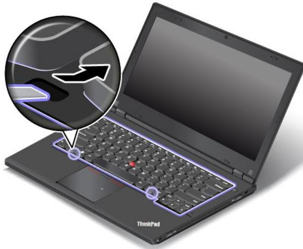
4. 使用鍵盤多功能工具的十字端鎖緊螺絲以固定鍵盤。
