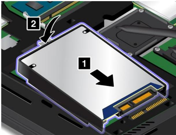
7. 鎖上螺絲以固定新的硬碟或固態硬碟。
