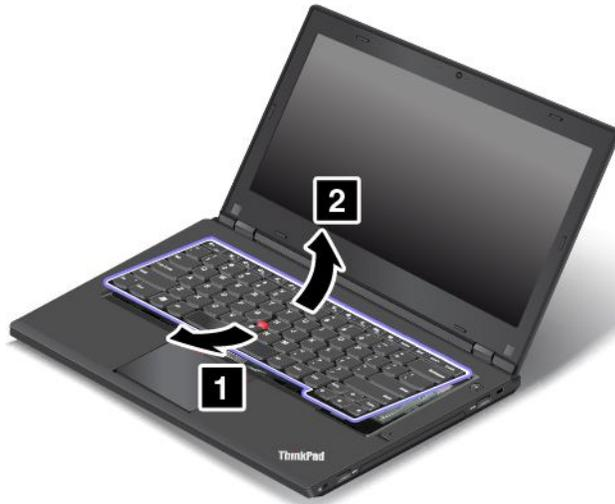
7. 將鍵盤放在置腕區上，然後拔掉接頭。然後拆下鍵盤。
