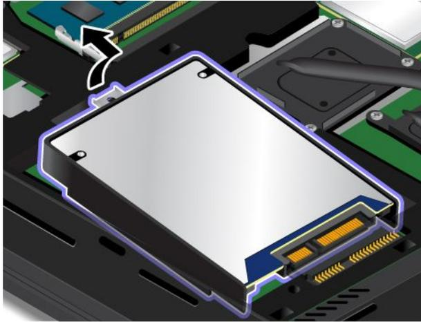
6. 安裝新的硬碟或固態硬碟。
