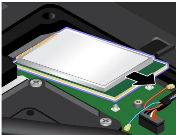
7. 將新無線 WAN 卡的缺口與插槽中的突起部分對齊。然後小心地將卡片以大約 20 度角插入插槽。
