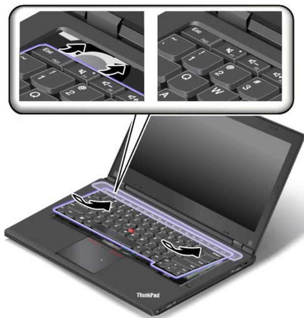
3. 確定螺絲頭都有露出。否則，請使用鍵盤多功能工具的平口端，將鍵盤框架向前滑動以露出螺絲頭。
