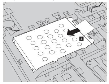
Extraiga la unidad de disco duro que está asegurada a una estructura metálica
