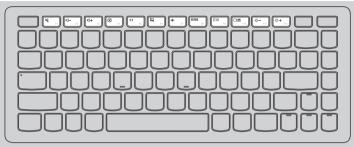
Ativa/desativa modo de Silencia/repõe o som. Avião. Exibe todas as atuais Diminui o nível de volume. aplicações ativas. Liga/desliga a Aumenta o nível de retroiluminação do ecrã volume. LCD. Alterna a visualização Fecha a atual janela ativa. entre o computador e o dispositivo externo. Atualiza o ambiente de trabalho ou a atual janela Diminui o brilho do ecrã. ativa. Ativa/desativa o touch Aumenta o brilho do ecrã. pad.
