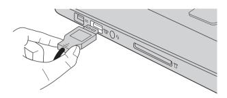
A primeira vez que ligar um dispositivo USB numa porta USB do seu computador, o Windows instala automaticamente um driver para esse dispositivo. Após o driver estar instalado, pode ligar e desligar o dispositivo sem executar outros passos adicionais.
