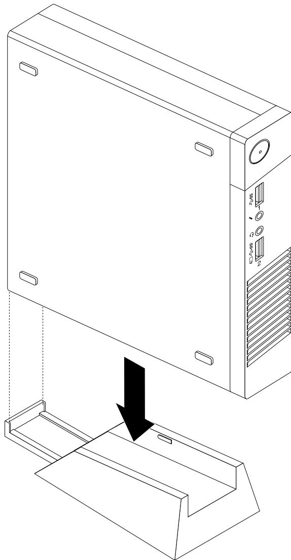
図9. 縦置きスタンドの取り付け
