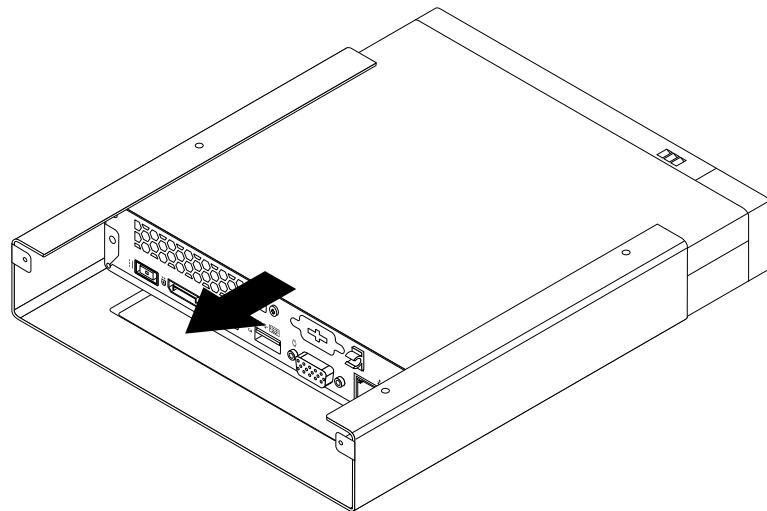
図11. VESA 取り付け金具の取り付け
