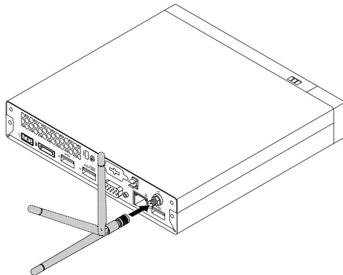
図58. 背面 Wi-Fi アンテナの取り付け
