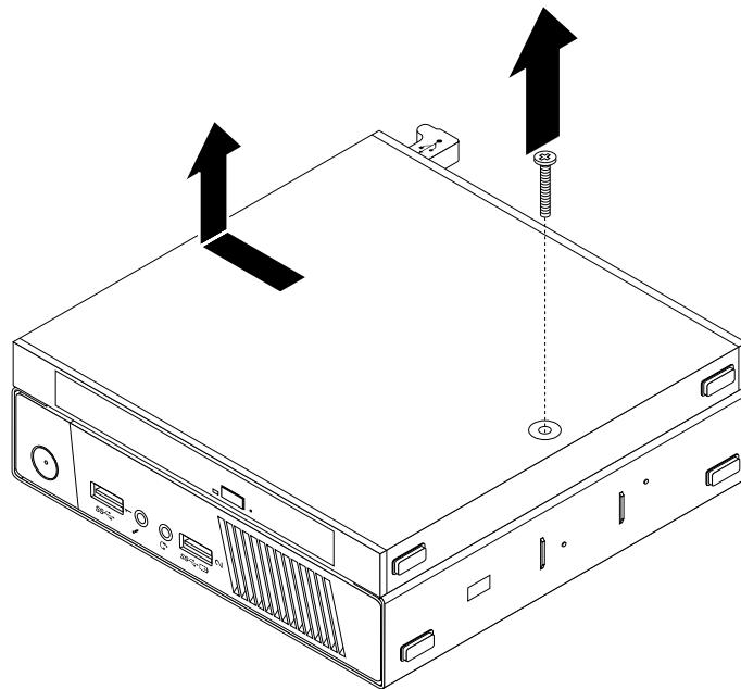
図25. 光学式ドライブ・ボックスの取り外し
