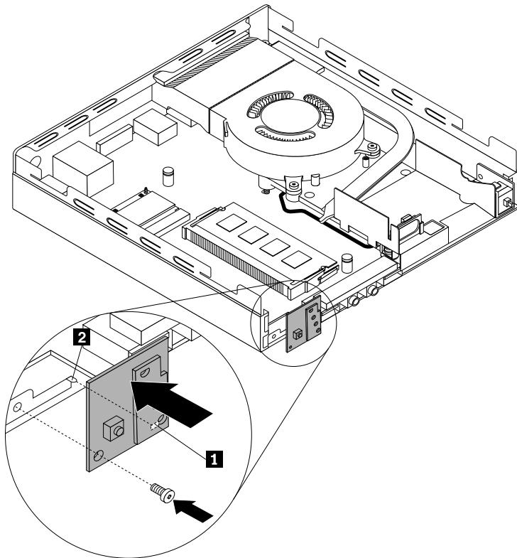
図48. 電源ボタン・ボードの取り付け
