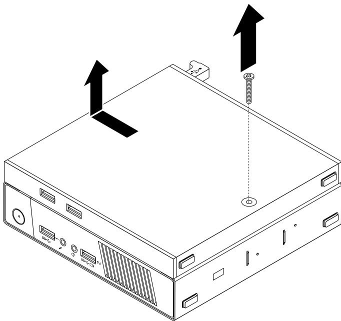
図35. I/O ボックスの取り外し
