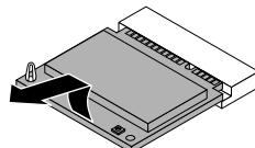
図50. Wi-Fi カード・モジュールの取り外し
