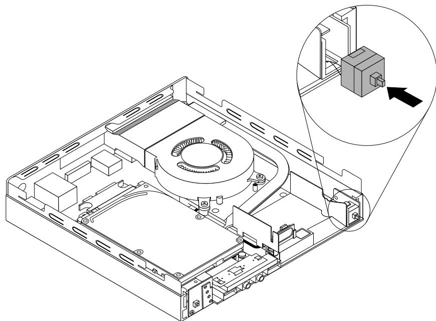
図65. カバー検出スイッチの取り付け
