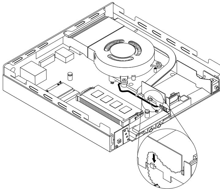
図63. 内蔵スピーカー・ケーブルの固定
