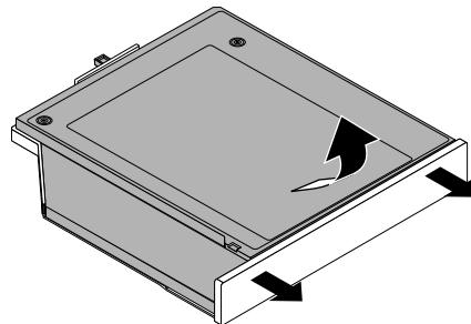
図27. アダプター・ブラケットからのハードディスク・ドライブ・アダプターの取り外し
