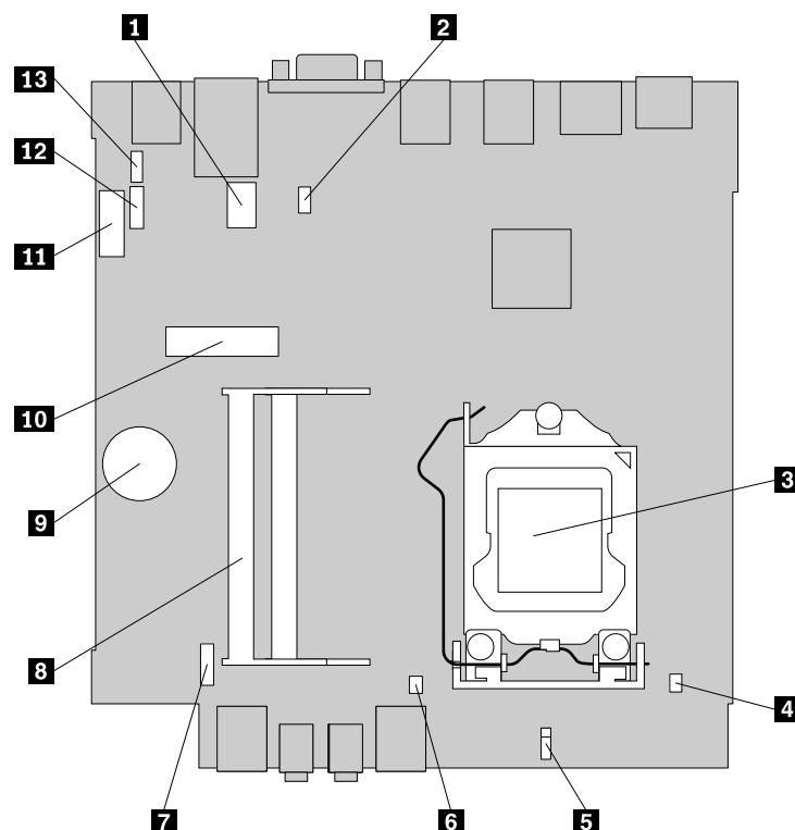
図4. システム・ボードの部品の位置
