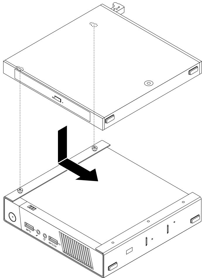
図23. 光学式ドライブ・ボックスの取り付け
