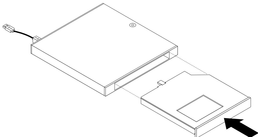
図32. 光学式ドライブ・ボックスへのアダプター・ブラケットの取り付け
