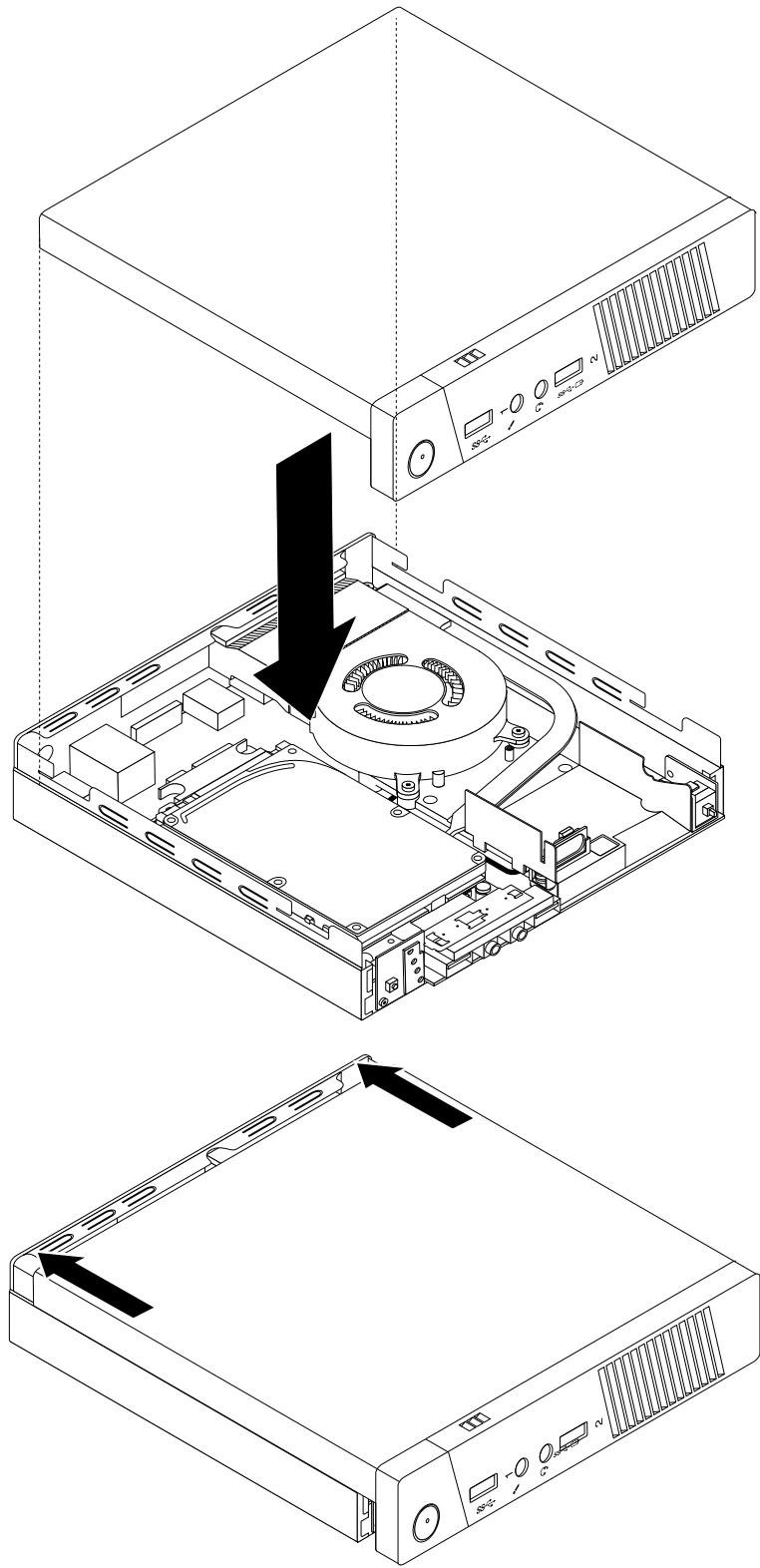
図74. コンピューターのカバーの取り付け
