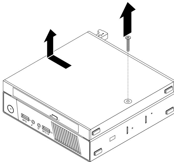
図17. 光学式ドライブ・ボックスの取り外し
