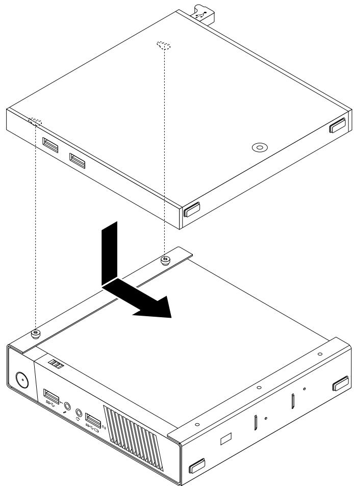
図36. I/O ボックスの取り付け
