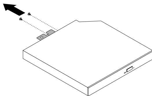
図19. 光学式ドライブの金属板の取り外し
