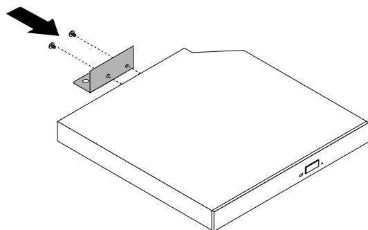
図20. 光学式ドライブの金属板の取り付け
