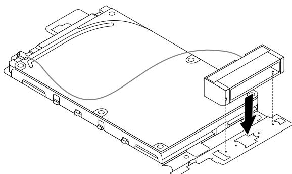
図54. 前面 Wi-Fi アンテナの貼り付け
