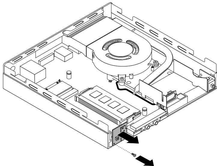
図47. 電源ボタン・ボードの取り外し
