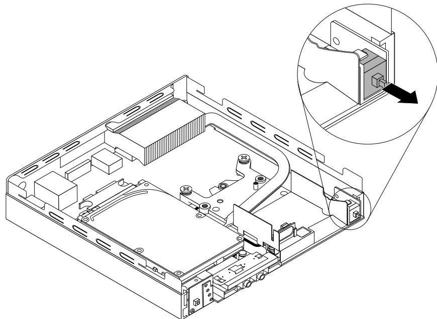
図64. カバー検出スイッチの取り外し
