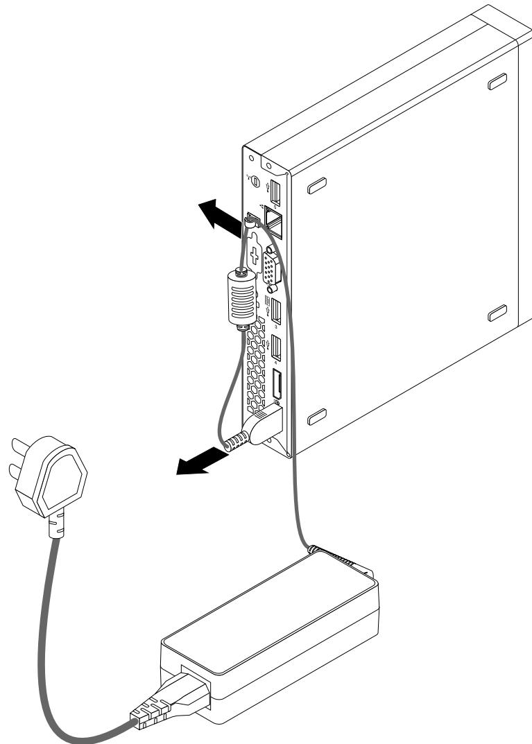
図8. AC 電源アダプターの取り外し
