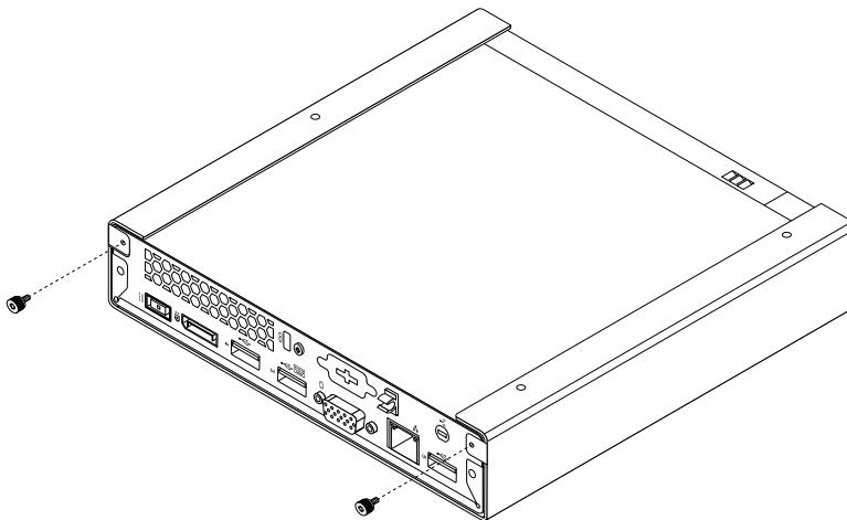
図12. VESA 取り付け金具を固定するねじの取り付け
