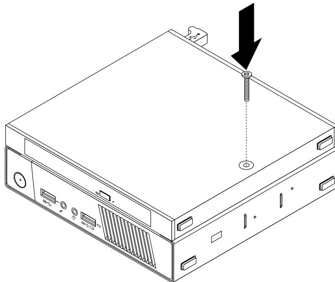
図34. 光学式ドライブ・ボックスを固定するねじの取り付け
