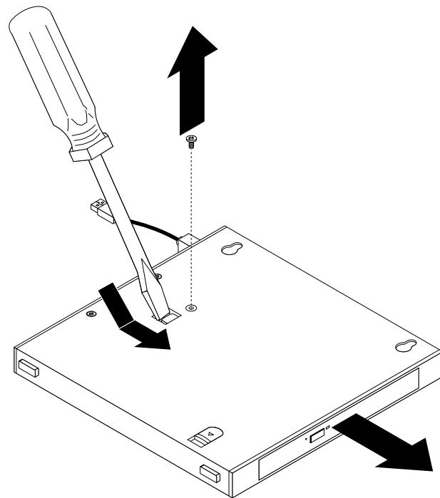
図18. 光学式ドライブ・ボックスからの光学式ドライブの取り外し
