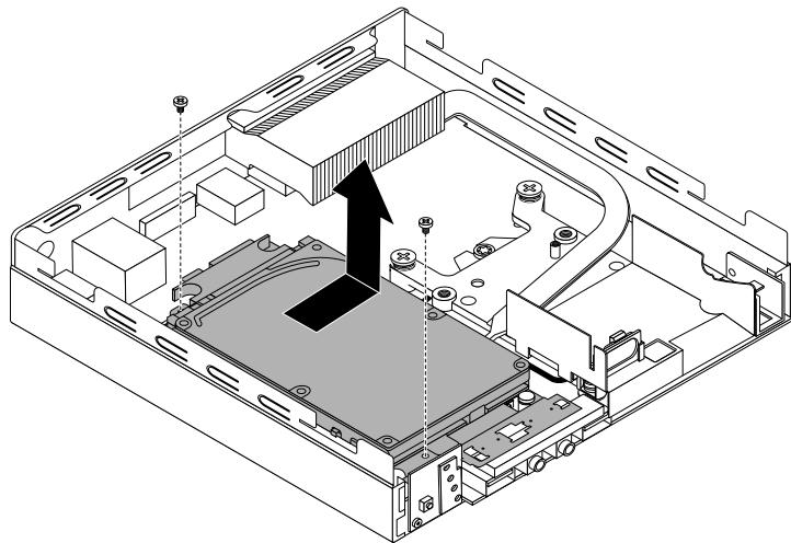
図40. ハードディスク・ドライブ・アセンブリーの取り外し
