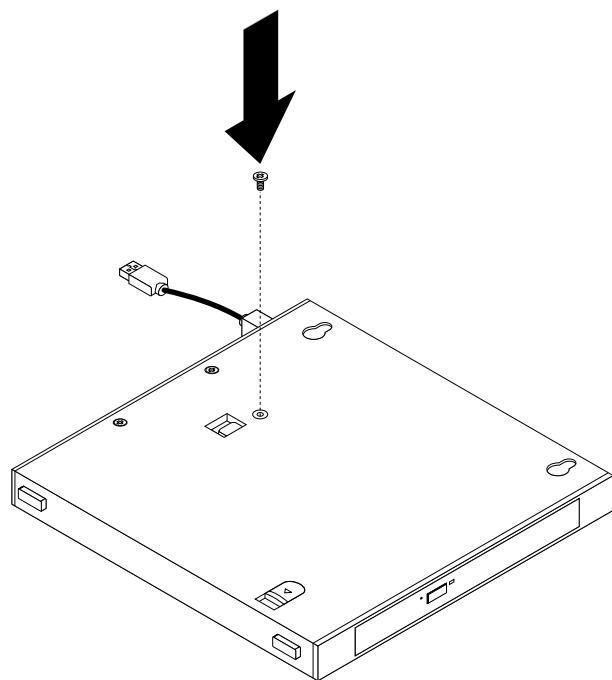
図22. 光学式ドライブを固定するねじの取り付け
