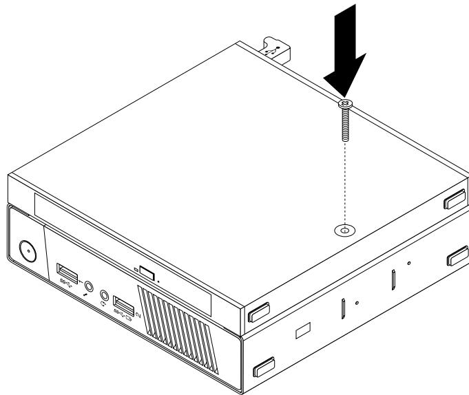
図24. 光学式ドライブ・ボックスを固定するねじの取り付け
