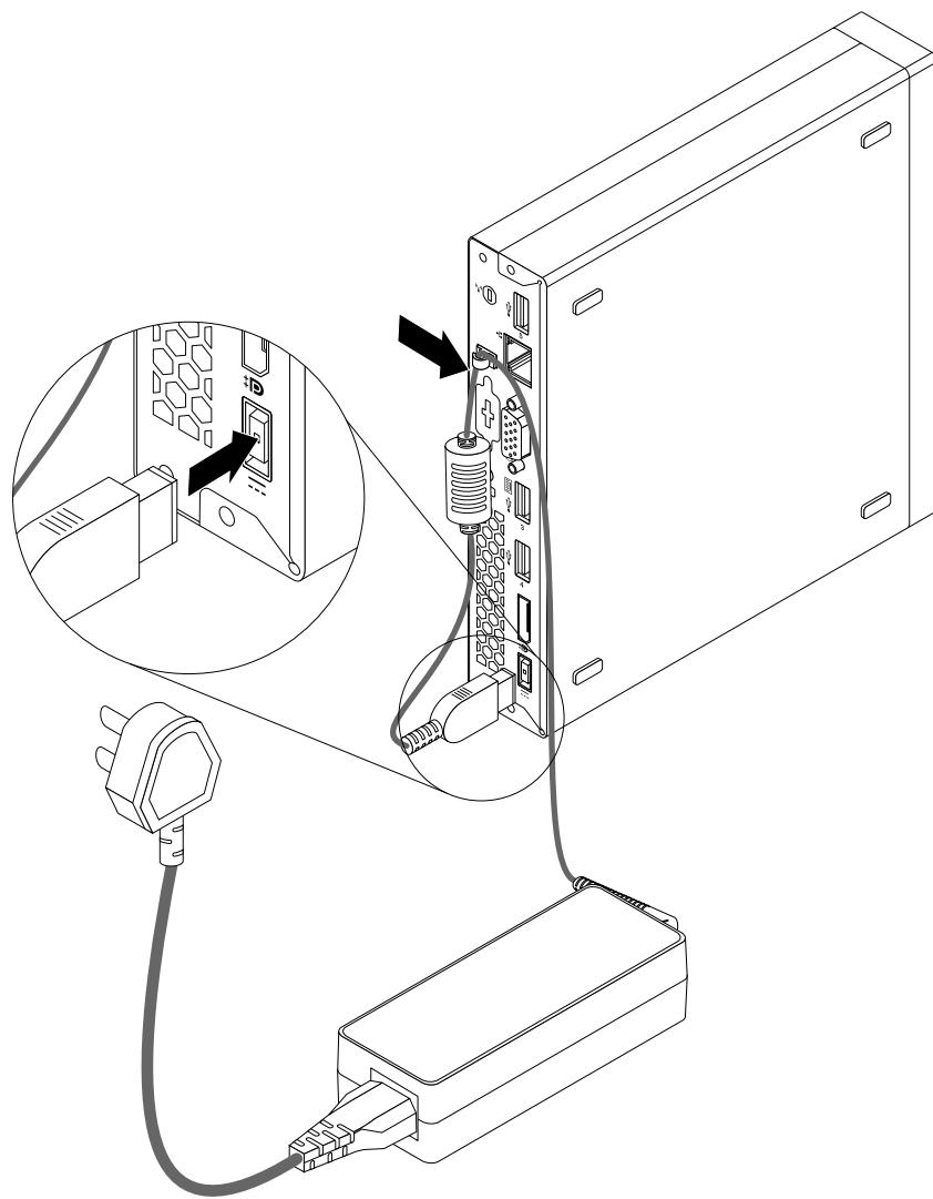
図7. AC 電源アダプターの接続
