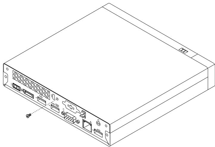
図38. コンピューター・カバーのねじの取り外し
