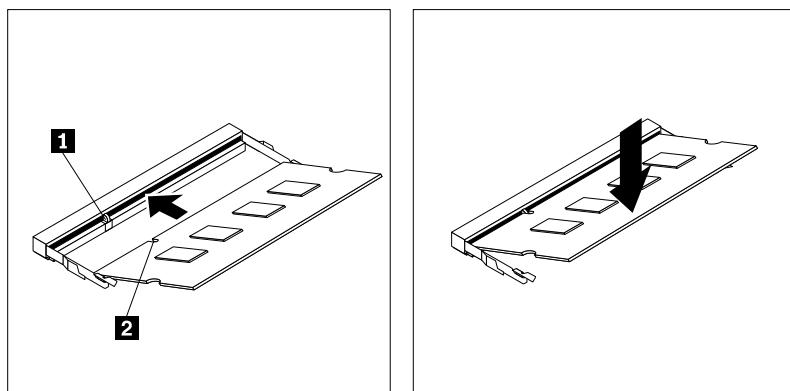
図44. メモリー・モジュールの取り付け
