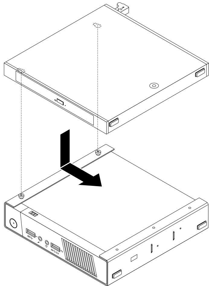
図33. 光学式ドライブ・ボックスの取り付け
