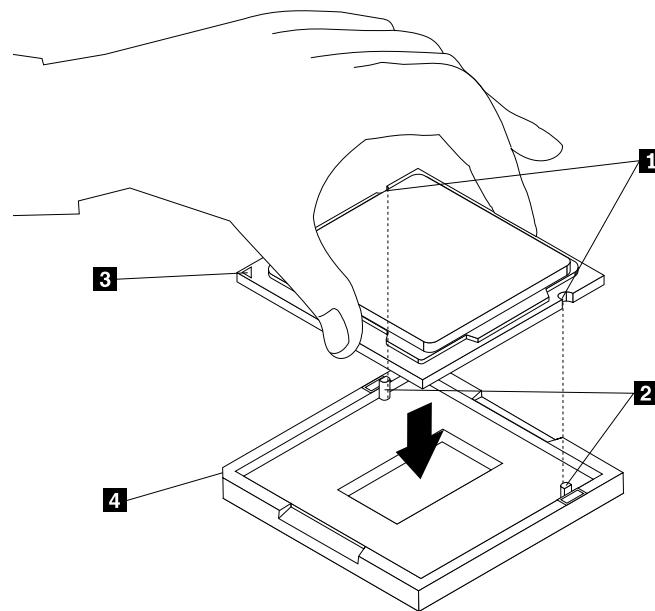
図72. マイクロプロセッサーの取り付け
