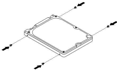
図29. 4本のねじをハードディスク・ドライブに取り付ける
