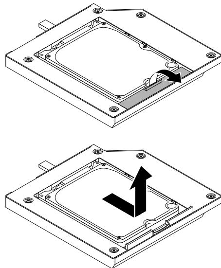
図28. アダプターからのセカンダリー・ハードディスク・ドライブの取り外し
