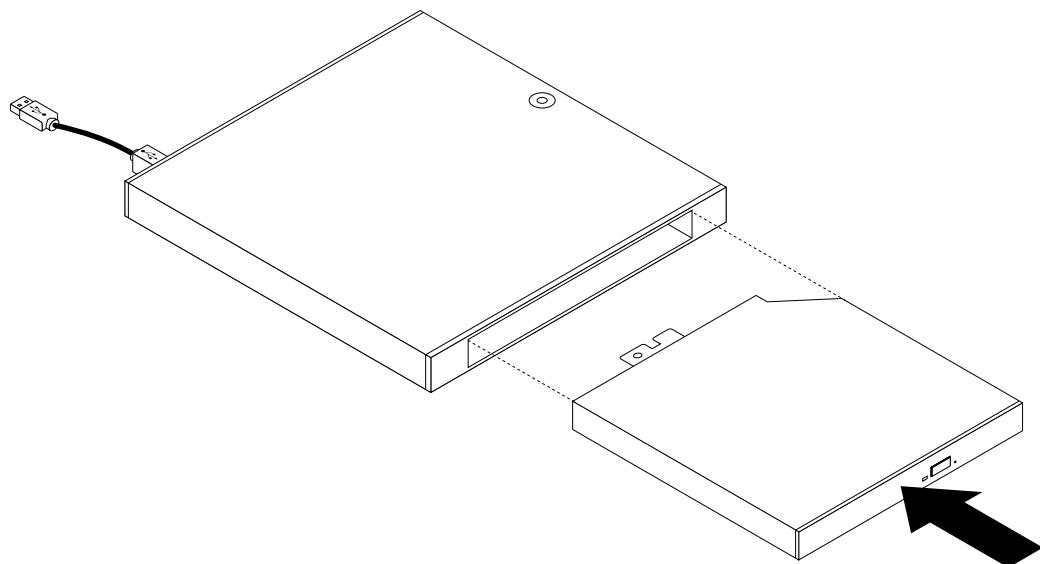
図21. 光学式ドライブ・ボックスへの光学式ドライブの取り付け
