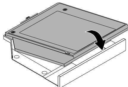
図31. アダプター・ブラケットへのハードディスク・ドライブ・アダプターの取り付け
