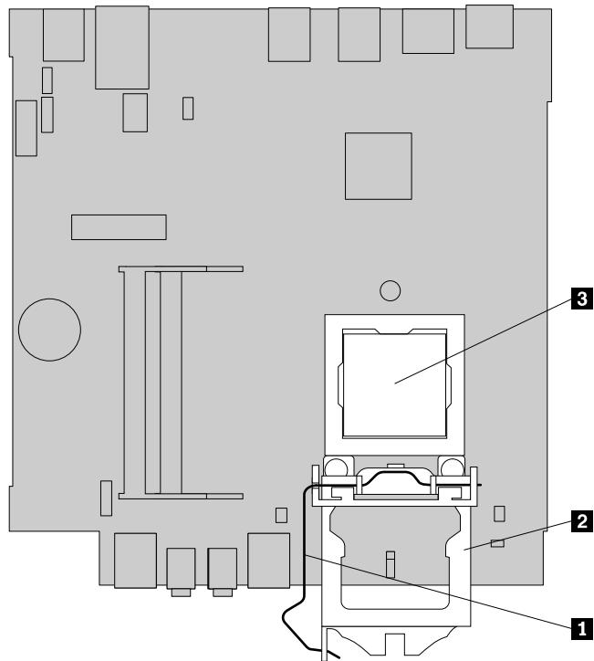
図70. マイクロプロセッサーへのアクセス
