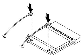
図52. Wi-Fi アンテナ・ケーブルの接続
