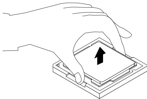
図71. マイクロプロセッサーの取り外し
