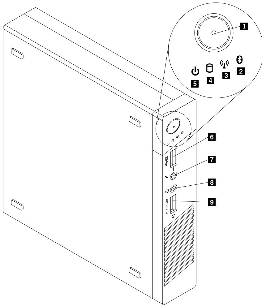
図1. 前面のコネクター、コントロール、インジケーターの位置
