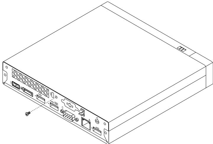
図75. コンピューター・カバーのねじの取り付け
