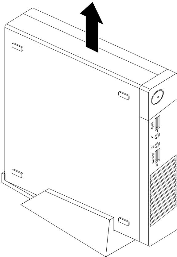
図10. 縦置きスタンドからのコンピューターの取り外し
