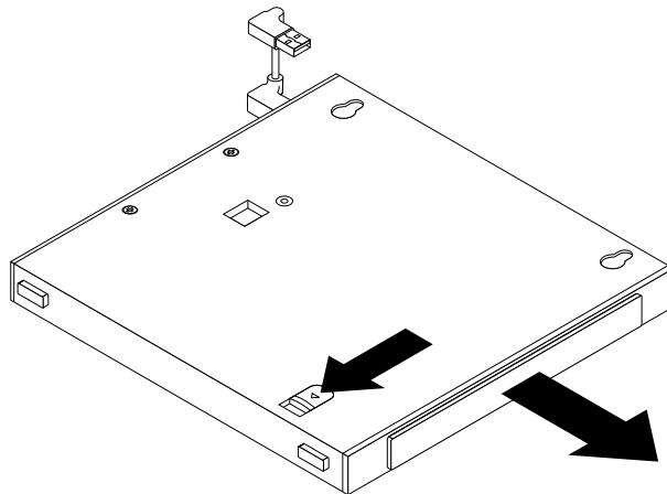
図26. 光学式ドライブボックスからのセカンダリー・ハードディスク・ドライブ・アダプターの取り外し
