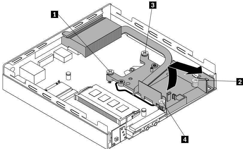
図 68. サーマル・モジュールの取り外し
