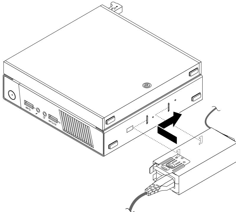
図 16. AC 電源アダプター・ブラケットの取り付け
