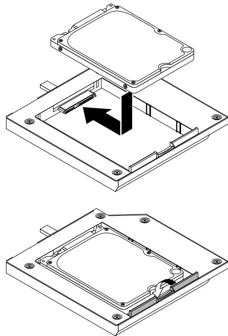
図30. アダプターへの新しいハードディスク・ドライブの取り付け
