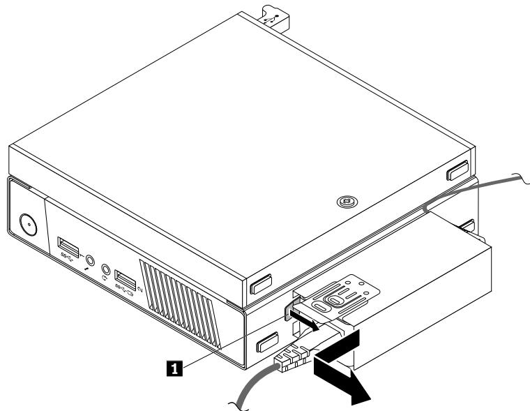
図 15. AC 電源アダプター・ブラケットの取り外し
