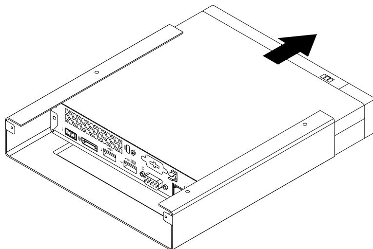
図14. VESA 取り付け金具の取り外し
