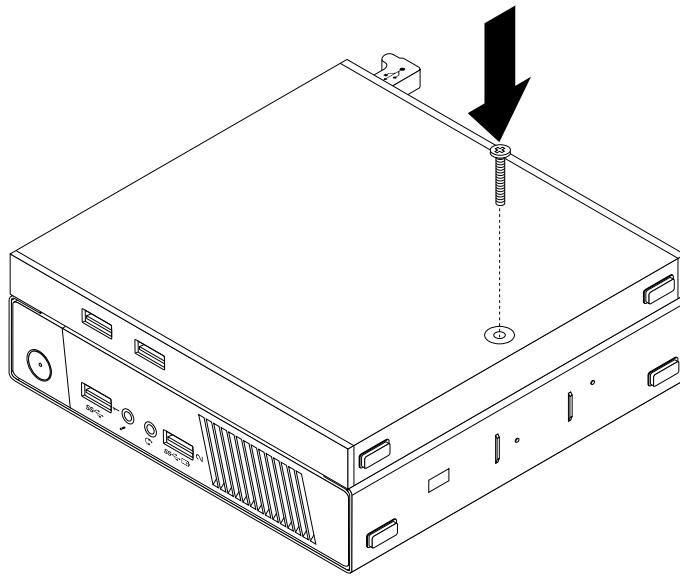
図37. ねじを取り付けて I/O ボックスを固定する
