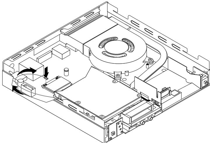
図 56. 前面 Wi-Fi アンテナ・ケーブルの取り付け
