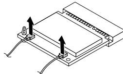
図49. Wi-Fi カード・モジュール・ケーブルの取り外し
