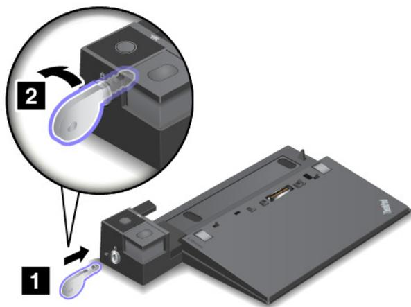
2. Conecte el equipo a la estación de acoplamiento, como se muestra, hasta escuchar un clic **1**. Gire la llave de bloqueo del sistema a la posición de bloqueado (vertical) **2**.
