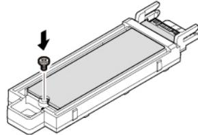
10. Deslice la bandeja a su lugar **1**. Si instala solo una unidad de estado sólido M.2, instálela en la bahía de la izquierda y luego vuelva a instalar el tornillo para fijar la bandeja **2**.
