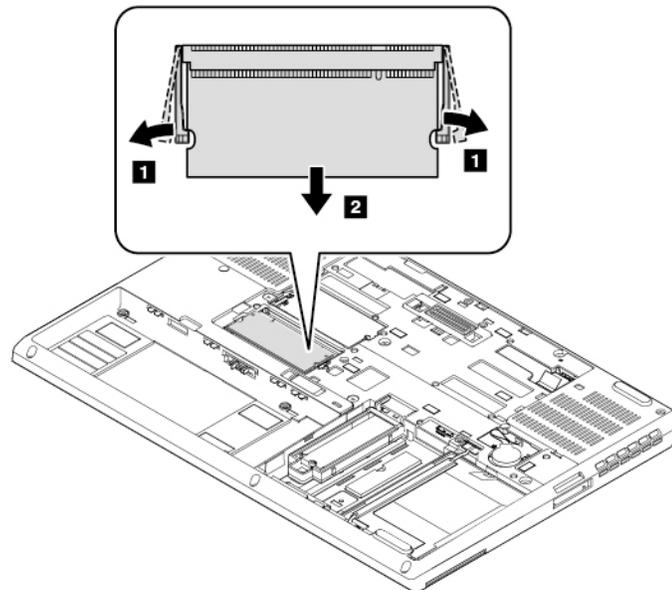
6. Inserte el nuevo módulo de memoria en la ranura de memoria, en un ángulo de aproximadamente 20 grados **1**. Gire el módulo de memoria hacia abajo hasta que encaje en su sitio **2**. Asegúrese de que el módulo de memoria instalado firmemente en la ranura y no se pueda mover con facilidad.
