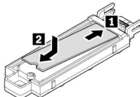
**Nota:** Asegúrese de seguir la marca de identificación en la bandeja al instalar la unidad de estado sólido M.2.
