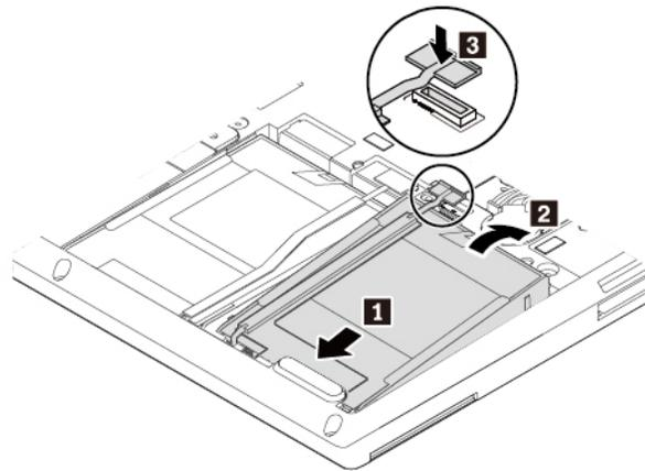
12. Vuelva a instalar la batería extraíble.
