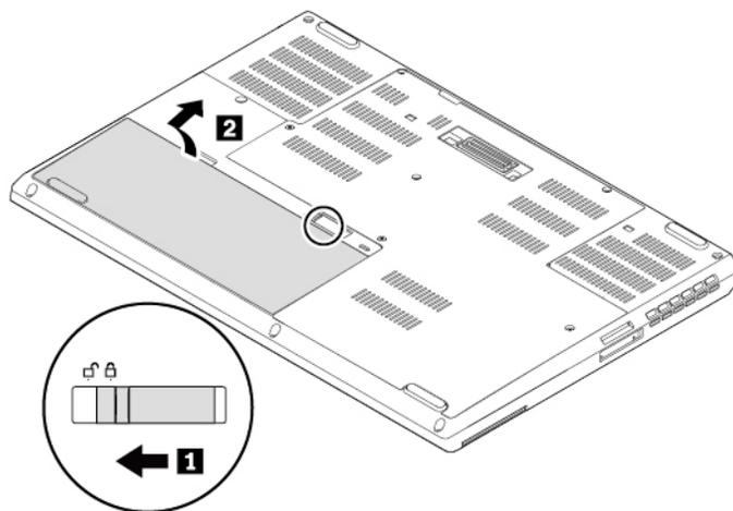
4. Inserte una batería nueva **1** y luego presiónela hasta que encaje en su lugar **2**. Asegúrese de que el mecanismo de cierre de la batería esté en la posición de bloqueo.
