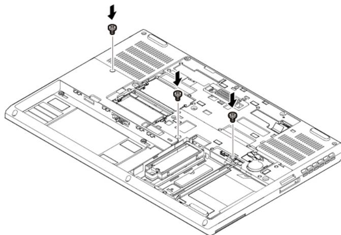
5. Vuelva a instalar la cubierta inferior.
