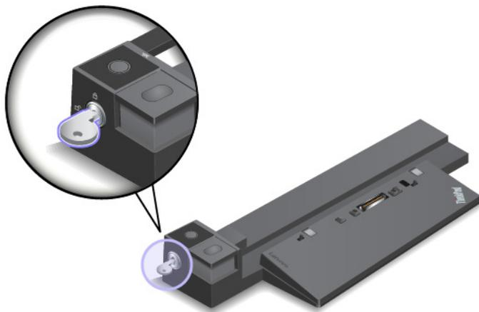
2. Conecte el equipo a la estación de acoplamiento, como se muestra, hasta escuchar un clic **1**. Gire la llave de bloqueo del sistema a la posición de bloqueo (vertical) **2**.
