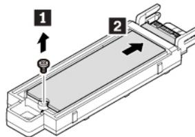
7. Presione suavemente la unidad de estado sólido M.2 **1** para girarla hacia arriba. Deslice la unidad de estado sólido M.2 hacia afuera de la bandeja, como muestra la flecha **2**.
