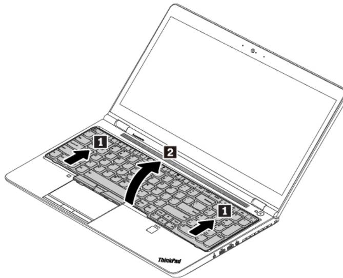
7. Gire el teclado ligeramente hacia arriba como muestra la flecha **1** hasta que vea los conectores en la parte inferior del teclado. Luego, gire el teclado como muestra la flecha **2**.
