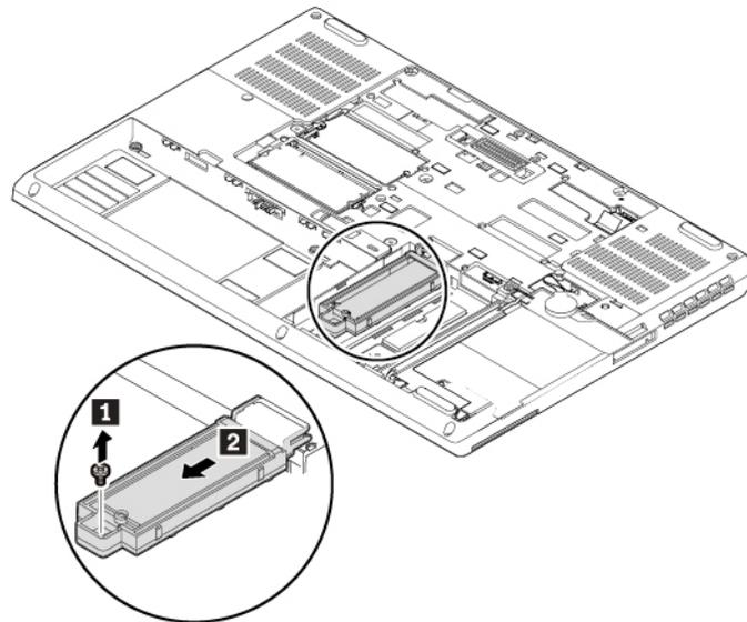
6. Extraiga el tornillo que fija la unidad de estado sólido M.2 **1** y luego empuje ligeramente la unidad de estado sólido M.2 como muestra la flecha **2**.
