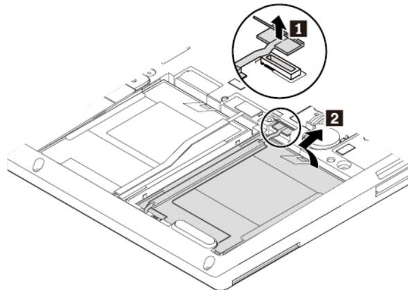
6. Desconecte el cable de la unidad de almacenamiento interna.
