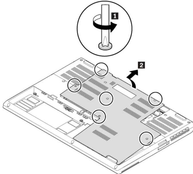
5. Instale la cubierta inferior nueva **1**. Apriete los tornillos para fijar la cubierta inferior **2**.
