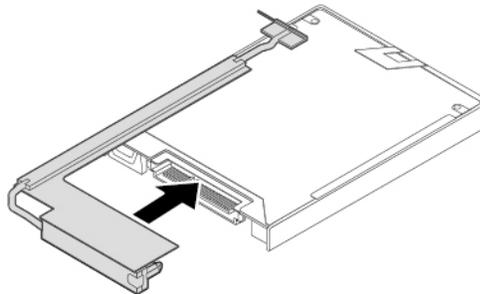
10. Inserte la nueva unidad de almacenamiento **1** en la bahía de unidad y gírela hacia abajo **2**. Asegúrese de que la nueva unidad de almacenamiento esté colocada en su lugar. Luego, conecte el conector a la placa del sistema **3**.
