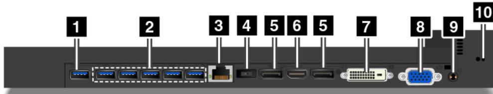
**1 Conector Always On USB:** conecta los dispositivos compatibles con USB o carga algunos dispositivos y smartphones digitales móviles.
