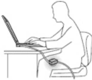
Cuando el adaptador de alimentación de CA está conectado a una toma de alimentación eléctrica y al sistema, genera calor.
