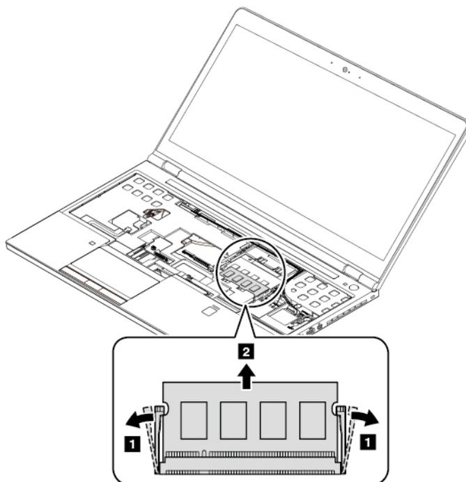
8. Inserte el nuevo módulo de memoria en la ranura de memoria, en un ángulo de aproximadamente 20 grados **1**. Gire el módulo de memoria hacia abajo hasta que encaje en su sitio **2**. Asegúrese de que el módulo de memoria instalado firmemente en la ranura y no se pueda mover con facilidad.
