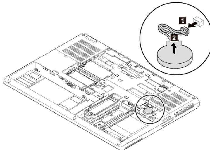
6. Instale la nueva batería plana **1** y conecte el conector **2**.
