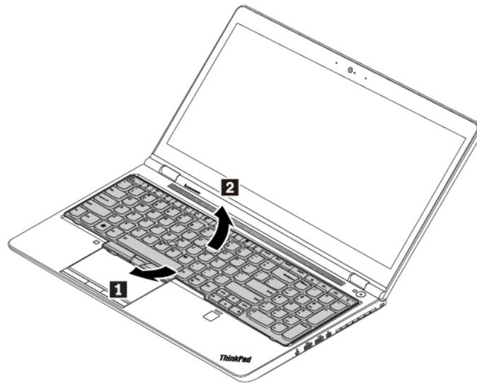
8. Coloque el teclado en el reposa manos como se indica y desconecte los conectores. Luego extraiga el teclado.
