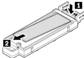
8. Deslice la nueva unidad de estado sólido M.2 hacia dentro de la bandeja, como muestra la flecha **1**. Luego mueva la unidad de estado sólido M.2 ligeramente hacia atrás, hasta que encaje en su posición **2**.
