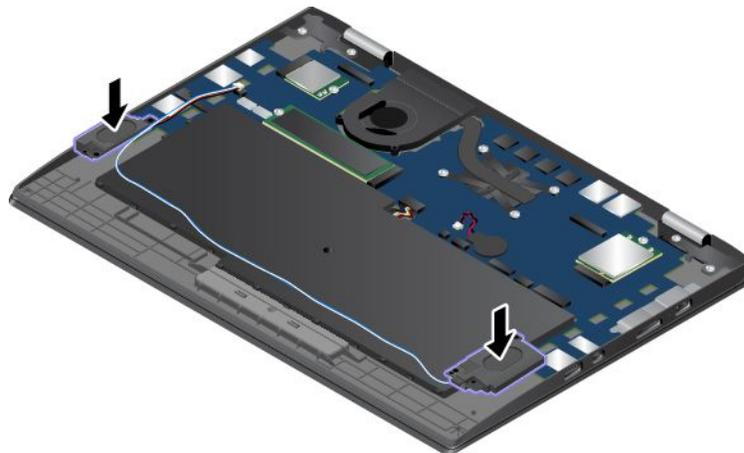
8. Bringen Sie die Schrauben an, um die Lautsprecher zu befestigen **1**, und schließen Sie den Anschluss wieder an **2**.
