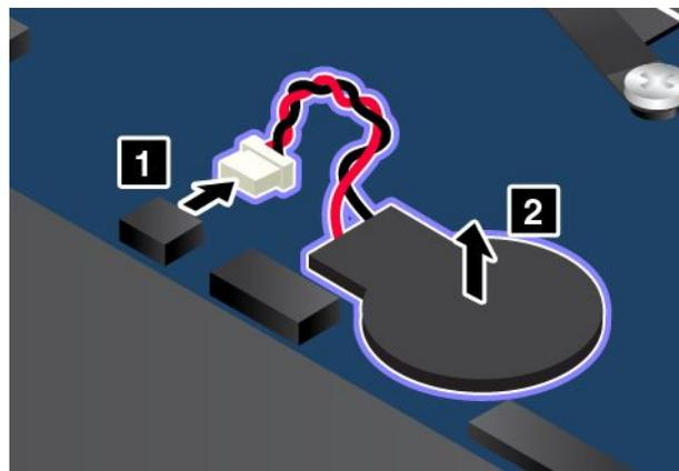
6. Setzen Sie die neue Knopfzellenbatterie **1** ein und schließen Sie dann den Stecker **2** an.
