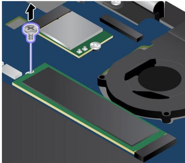
6. Entfernen Sie das M.2-Solid-State-Laufwerk.
