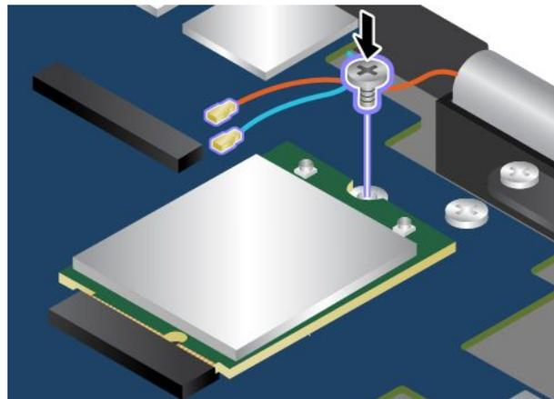
8. Schließen Sie die Antennenkabel an die neue Karte für drahtlose WAN-Verbindungen an. Stellen Sie sicher, dass das rote Kabel am Hauptanschluss der Karte und das blaue Kabel am AUX-Anschluss der Karte angeschlossen ist.
