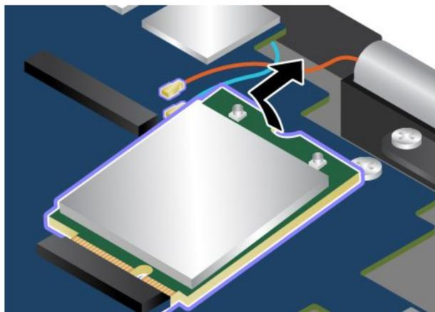
6. Richten Sie die Kante der neuen Karte für drahtlose WAN-Verbindungen mit der Einkerbung an der Aussparung des zugehörigen Steckplatzes aus. Setzen Sie dann die Karte vorsichtig in einem Winkel von ca. 20 Grad in den Steckplatz ein.
