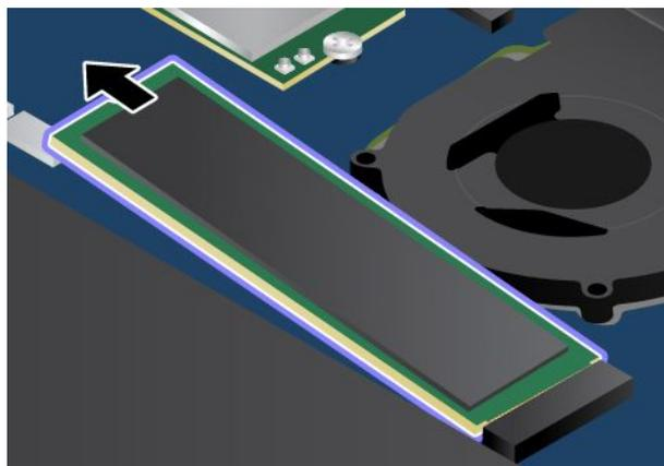
7. Installieren Sie das neue M.2-Solid-State-Laufwerk.
