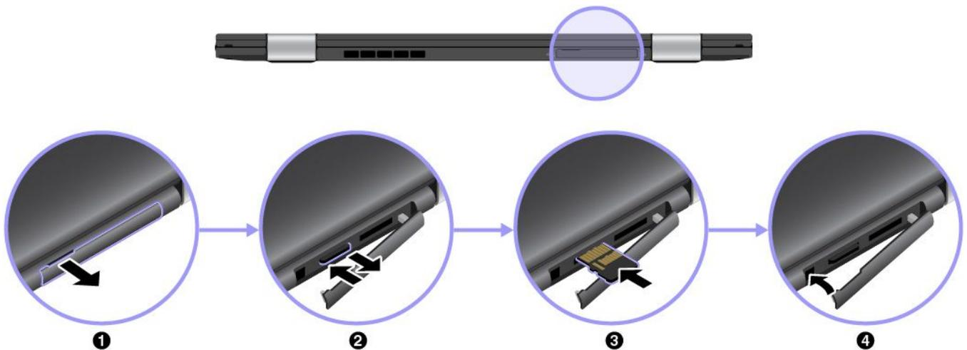
1. Öffnen Sie die Abdeckung des microSD-Kartensteckplatzes an der Rückseite des Computers.
