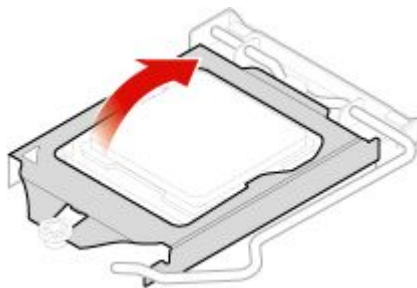
図 116. マイクロプロセッサ・ソケットを上方向に回転させる
