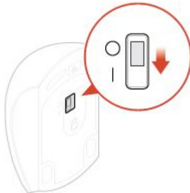
図 17. バッテリー・コンパートメントのカバーを閉じる
