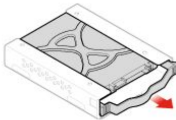
図 42. 2.5 型セカンダリー・ストレージ・ドライブ・ブラケットの取り外し
