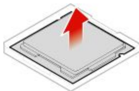
図 116. マイクロプロセッサ・ソケットを上方向に回転させる
