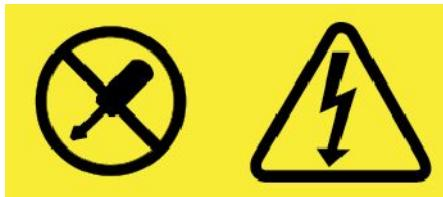
任何贴有此标签的组件内部都有危险的电压、电流和能量级别。这些组件内没有可维修的部件。如果您怀疑某个部件有问题，请与技术服务人员联系。
