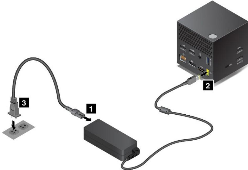
1. 将电源线连接到交流电源适配器。
