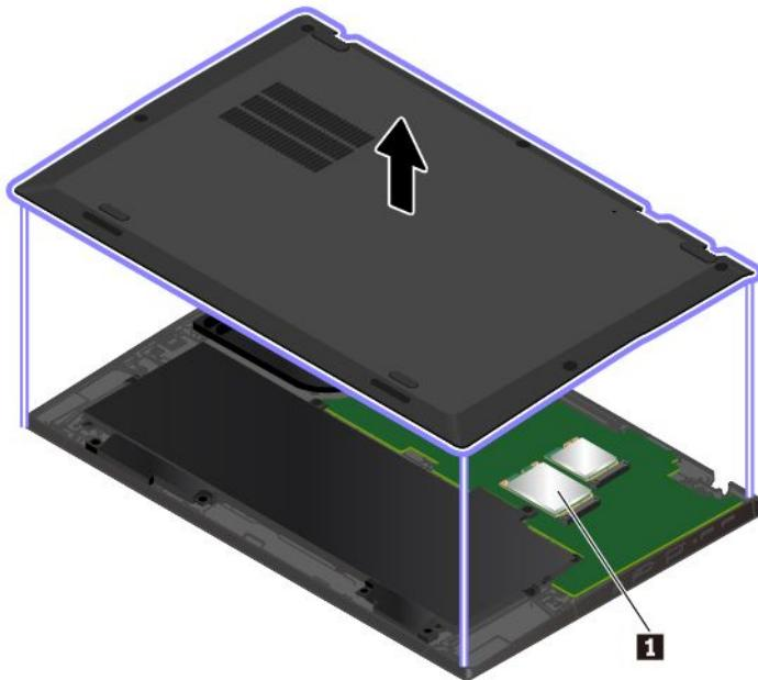
注：对于用户可安装的无线模块，请确保只将 **Lenovo** 授权的无线模块用于计算机。否则，开启计算机时将显示一条错误消息，并发出蜂鸣声。
