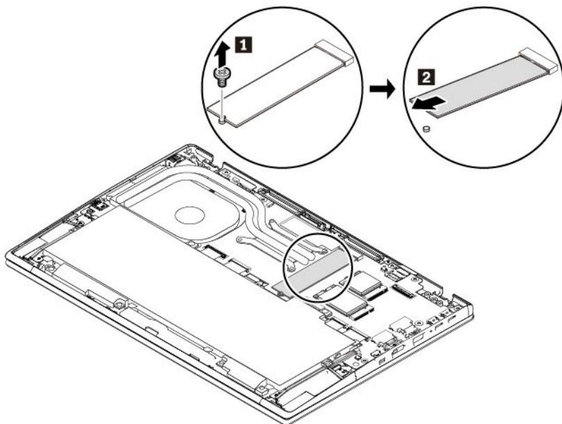
6. 要安装新的 M.2 固态驱动器，请执行以下操作：
