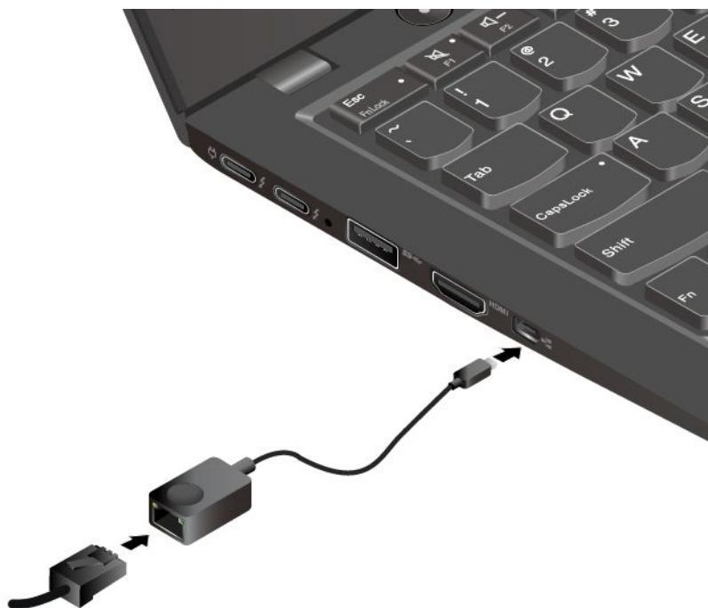
以太网接口有两个指示灯，用于显示网络连接的状态。当绿色指示灯点亮时，表示计算机已连接到局域网。当黄色指示灯闪烁时，表示正在传输数据。
