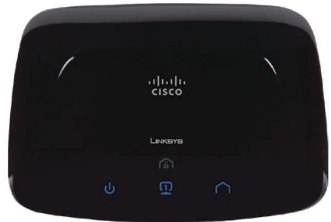
I LED Power, Ethernet e Powerline sono illuminati
