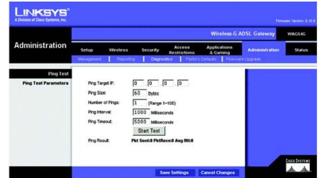
Abbildung 5-35: Ping Test (Ping-Test)
