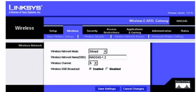
Abbildung 5-13: Wireless Network Mode (Wireless-Netzwerkmodus)
