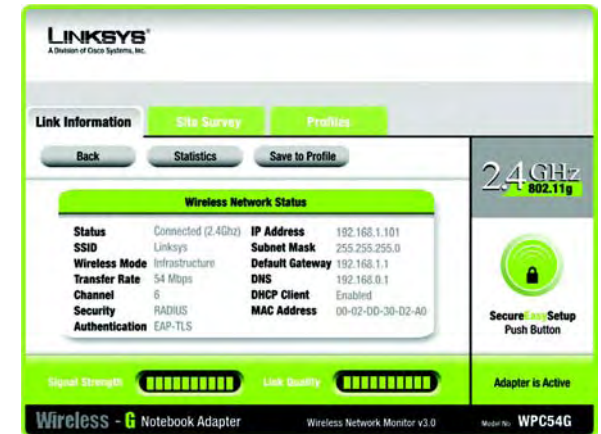
Figura 5-3: Mais informações - Wireless Network Status (Estado da rede sem fios)
