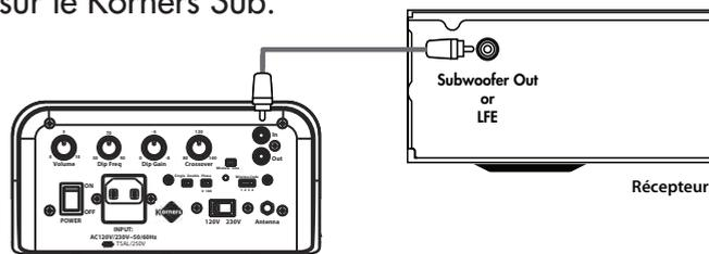
**La sortie ligne** - La sortie ligne est utilisé pour envoyer le signal d'entrée à un autre Sous Korner's lors de la connexion ainsi que deux sous-marins. Physiquement connecter deux Korner's Subs ensemble, vous aurez besoin de l'option Korner's Sub Connector.
