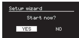
Per avviare il wizard di impostazione, ruotare la **MANOPOLA DI CONTROLLO** per evidenziare **YES** quindi premere la manopola per selezionarla. Selezionando **NO**, sarà possibile eseguire il wizard alla successiva accensione del dispositivo R2 che si avvia senza configurazione di data/ora e impostazioni di rete.
