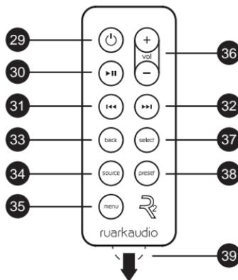
***N.B.:** voordat je je afstandsbediening voor het eerst gebruikt moet je de oranje kunststoftab (39) verwijderen om de batterij te activeren.*
