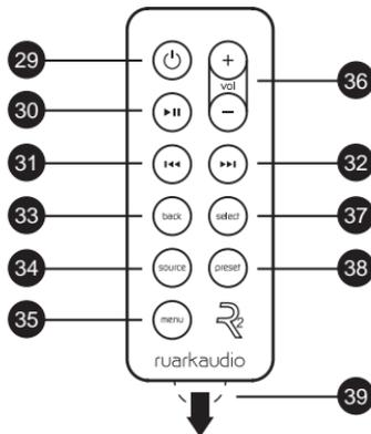
**MERK:** Før du bruker fjernkontrollen for første gang må du fjerne den oransje plaststrimlen (39) for å koble inn batteriet.
