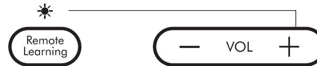
Schritt 3: Während zeigte Ihrem Fernseher oder Kabel/Sat Fernbedienung Die 4TV, drücken Sie die Lautstärke + Taste auf der Fernbedienung 4 mal sein gelernt. Die Remote Learning Licht und die Volume + Licht auf die 4TV blinkt 4 mal und dann ausschalten, um zu bestätigen.
