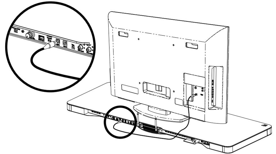
**Ger Anschluss:** Analog, RCA-Kabel
