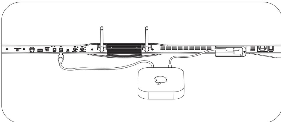
Nach Herstellung der Stromversorgung schließen Sie das digital-optische Audio-Kabel des Airport Express an den digital-optischen Eingang, der mit "Airport" bezeichnet ist, an.
