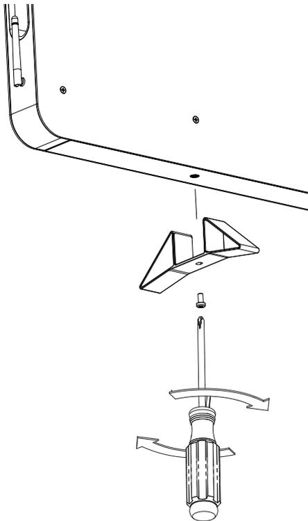
Für die vertikale Positionierung angebracht Fuß inklusive des Subwoofers, wie dargestellt. Eine einzelne Schraube hält bequem jeder Fuß.
