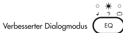
LDie 4TV bietet einen Enhanced Dialogue Mode zur optimierten Dialogklangerfassung für Film und Fernsehen. Zur Aktivierung dieses optimierten Dialogmodus drücken Sie einfach die Taste "EQ" auf der Bedienleiste, bis die blaue Leuchte über dem "Ohr"-Icon steht.
