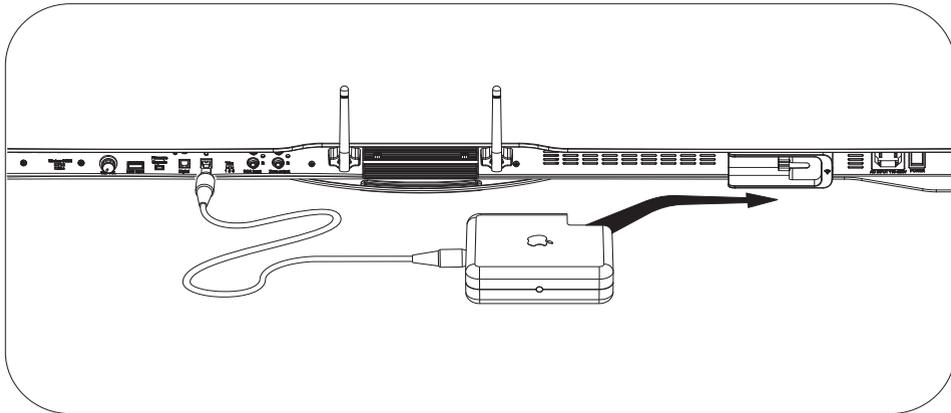
Zum Anschluss eines neuen Airport Express an die 4TV benutzen Sie das beigegefügte Adapterkabel (siehe Abb.).
