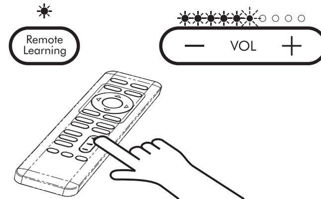
Wiederholen Sie die Schritte 1 bis 3, um die übrigen Fernbedienungsfunktionen zu programmieren (Lautstärke reduzieren, Einschalten und Stummschalten)
