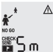
Si votre Barryvox® constate que la fréquence d'émission de l'appareil testé est différente de la norme prescrite, l'appareil affiche un avertissement. Dans ce cas, répétez le test avec une distance de 5 m entre les participants de manière à identifier l'émetteur défectueux. De tels appareils doivent être vérifiés par le fabricant.
