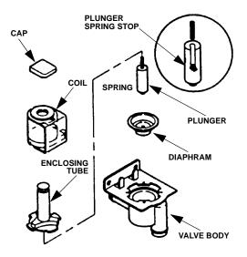
Figure 3-8. Dump Valve Disassembly
