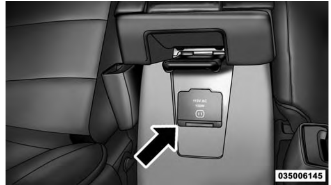
115 Volt Power Outlet
