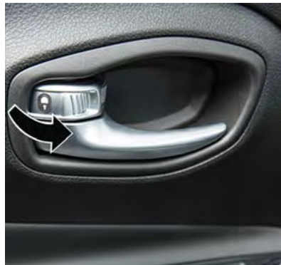
Manual Door Lock
