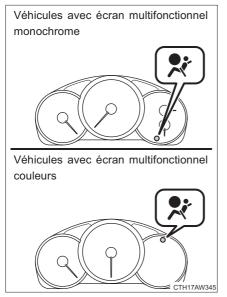
Un système de diagnostic continuellement contrôle fonctionnalité dи système d'airbag SRS (y-compris les prétensionneurs des ceintures de sécurité avants) lors de la conduite du véhicule. Le témoin lumineux du système d'airbags SRS montrera l'opération normale en s'allumant pendant environ 6 secondes quand le contacteur de démarrage est mis en position "ON".
