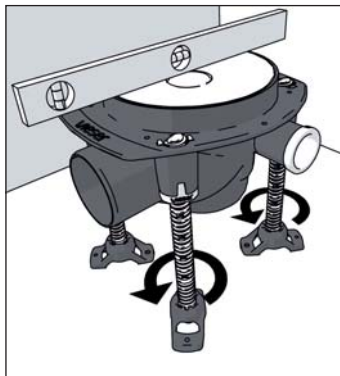
Kuva 93. Vieser One -lattiakaivon tukeminen betonivalun yhteydessä.
